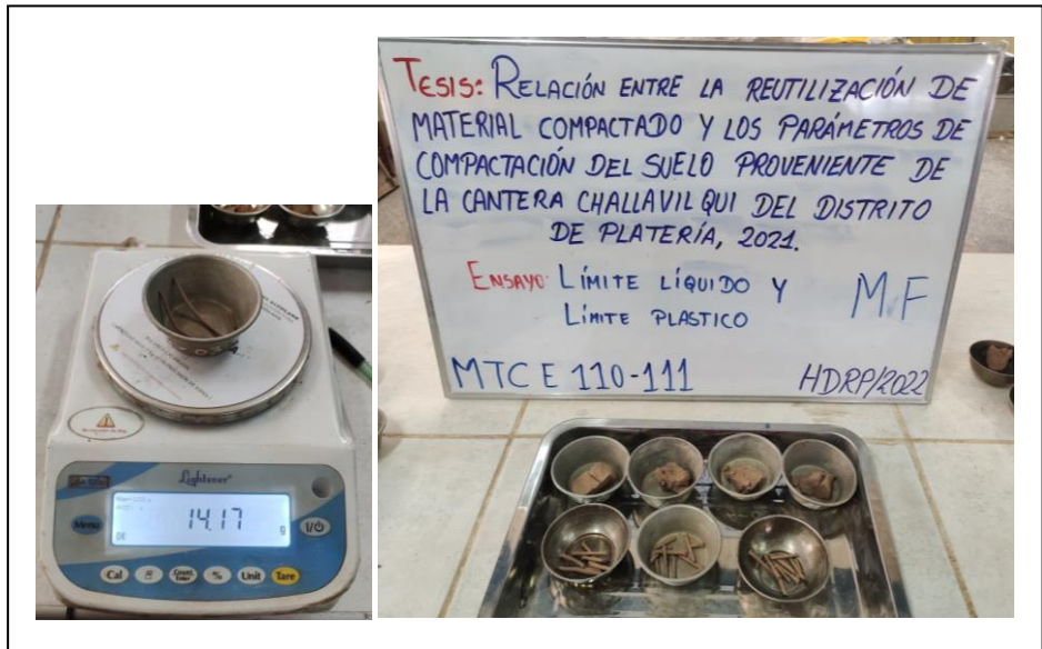
FOTO N° 19 ENSAYO DE LÍMITE PLÁSTICO, PESAJE DE LOS "BASTONES" DE TIERRA. RESULTADO ENSAYO DE LÍMITES DE ATTERBERG MUESTRA FINAL.
