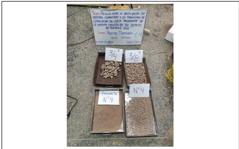
FOTO N° 20 SELECCIÓN DEL MÉTODO DE COMPACTACIÓN A LA MUESTRA FINAL.
