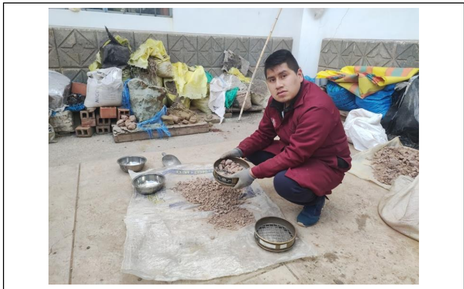
FOTO N° 21 SELECCIÓN DE MATERIAL POR CADA TAMIZ ADECUADO, PREPARACIÓN PARA ENSAYO DE PROCTOR MODIFICADO.
