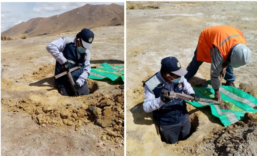
*Figura 11.* Obtención de la muestra en la cancha de relave
