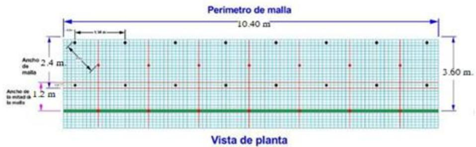
*Figura 5.* Diseño de malla electrosoldada y pernos Hydrabolt
