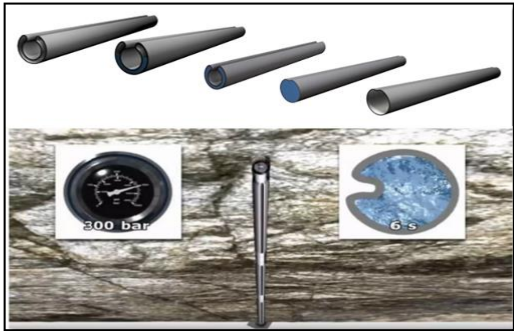
Figura 6. Proceso de inflado del Omega Bolt.
