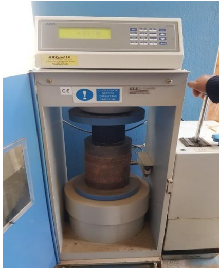
Figura 34. Realización del ensayo de resistencia a compresión simple de mezclas asfálticas
