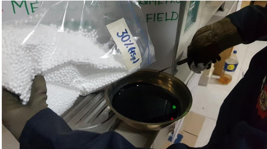
Figura 30. Incorporación del POLIMERO EPS al cemento asfáltico, a una temperatura de 170°C
