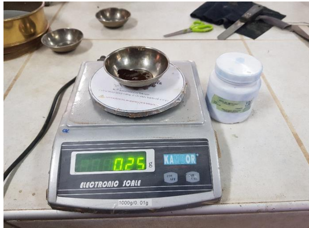
Figura 20. Resultado obtenido después de haberse realizado el ensayo de azul de metileno en los agregados finos.
