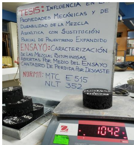
Figura 36. Resultado de la primera probeta luego de ser sometida a desgaste mediante la máquina de los ángeles
