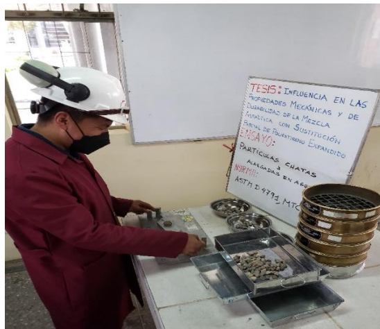
Figura 9. Separación de partículas chatas y alargadas
