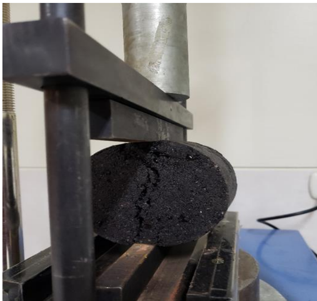
Figura 38. Espécimen luego de ser sometido al ensayo de tracción indirecta
