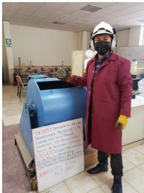
Figura 36. Resultado de la primera probeta luego de ser sometida a desgaste mediante la máquina de los ángeles
