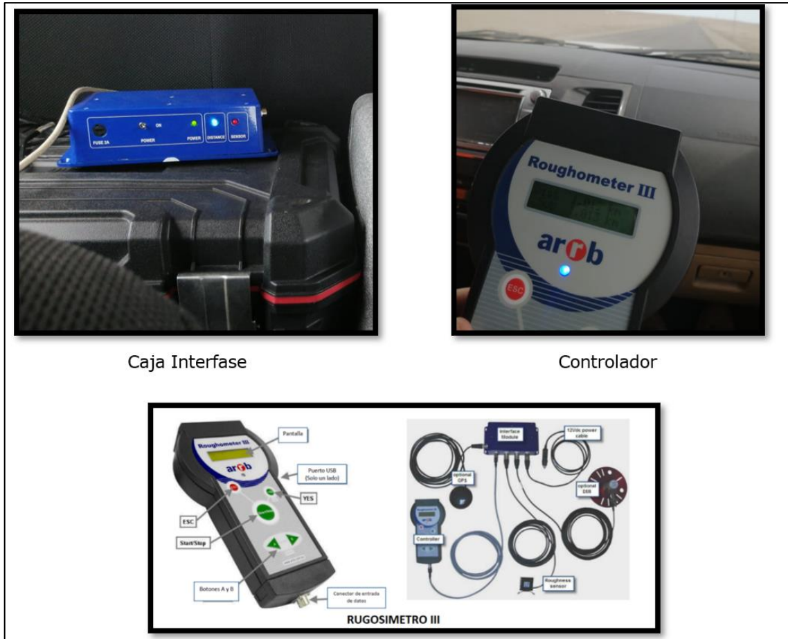
Figura 8. Rugosímetro III Componentes adquiridor de datos, mostrando como se conectan entre sí
