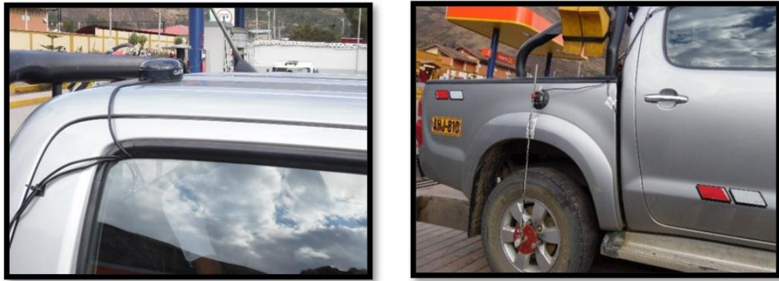
Figura 9. Instalación del rugosímetro en el vehículo
