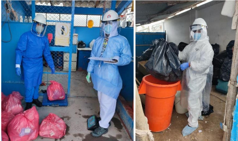
Figura 17. A. Pesaje de muestras de residuos sólidos B. Determinación de volumen de residuos sólidos
