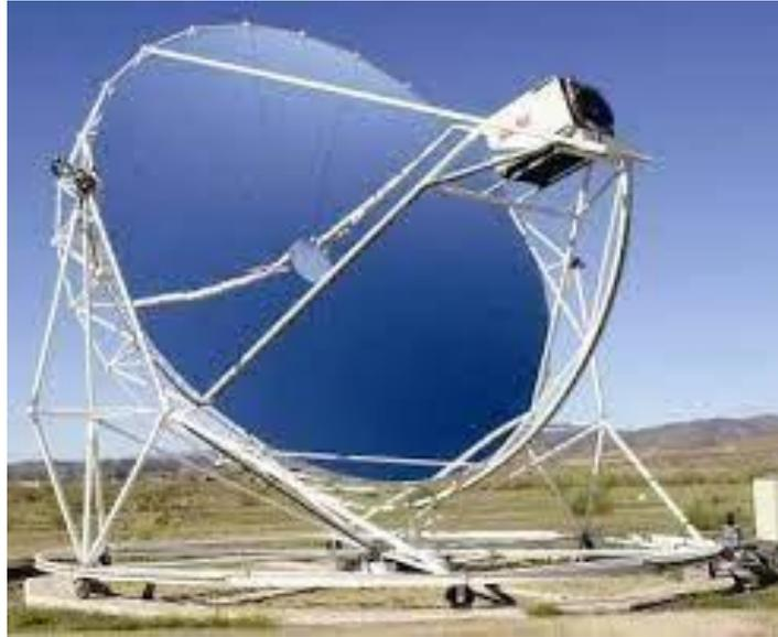
**Figura 11:** Disco parabólico con motor stirling
