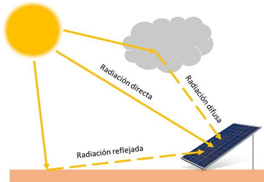
**Figura 3:** Radiación solar recibida por los sistemas de aprovechamiento de energía
