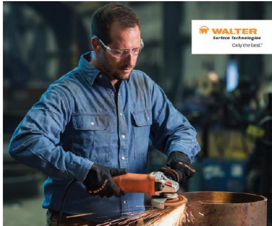
Figura 8. Preparación de material con esmeril de mano
