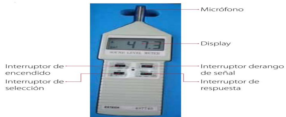
Figura 5. Partes del sonómetro EXTECH, modelo 407740
