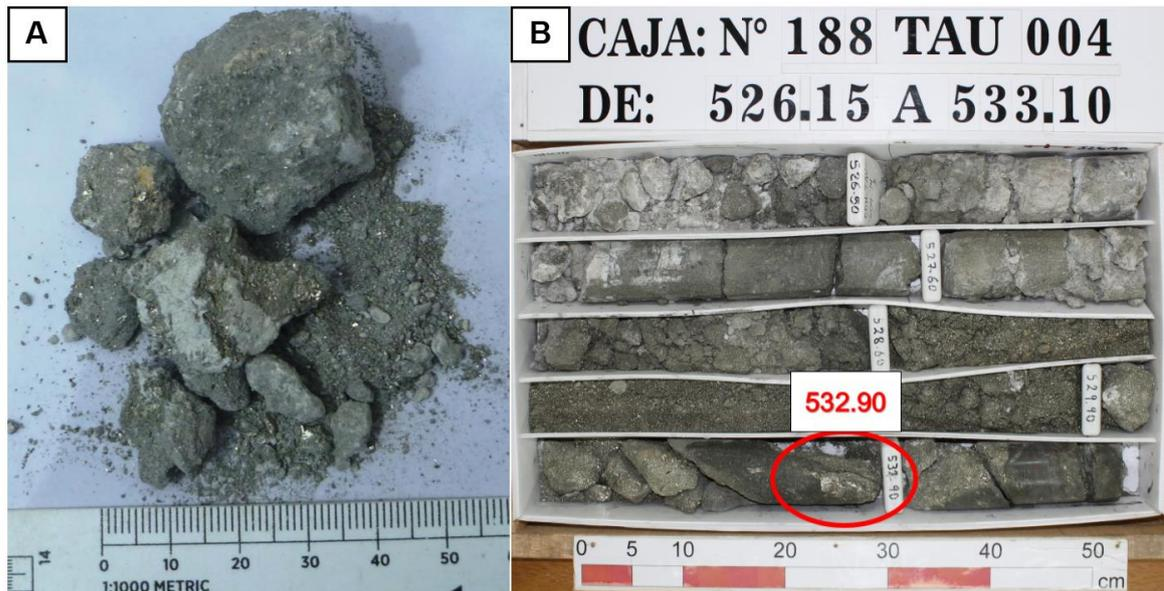
**Figura 43.** Muestra N° 4 para análisis SEM. **A:** Muestra de mano. **B:** Metraje perforado de donde se obtuvo la muestra.
