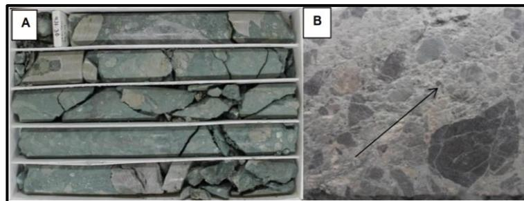
*Figura 14. A:* Brecha de falla. *B:* Brecha con alineamiento de fragmentos producto de reactivaciones de la falla.
