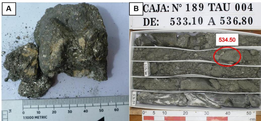
**Figura 47.** Muestra N° 5 para análisis SEM. **A:** Muestra de mano. **B:** Metraje perforado de donde se obtuvo la muestra.
