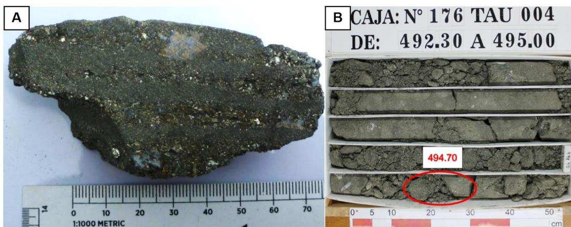
**Figura 40.** Muestra N° 3 para análisis SEM. **A:** Muestra de mano. **B:** Metraje perforado de donde se obtuvo la muestra.
