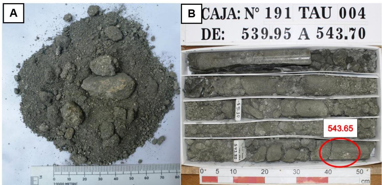
**Figura 52.** Muestra N° 6 para análisis SEM. **A:** Muestra de mano. **B:** Metraje perforado de donde se obtuvo la muestra.
