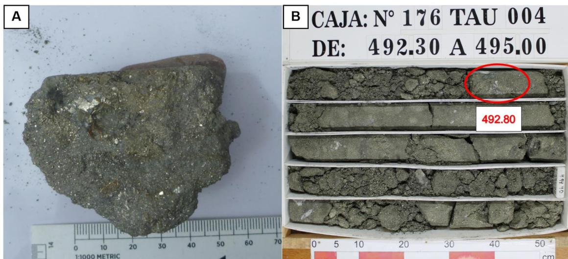
**Figura 37.** Muestra N° 2 para análisis de Microscopía Electrónica de Barrido (SEM). **A:** Muestra de mano. **B:** Metraje perforado de donde se obtuvo la muestra.
