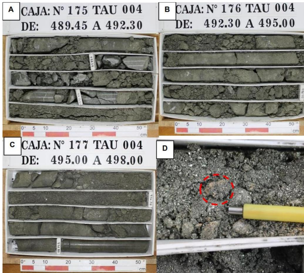
**Figura 29.** A, B y C: TAU004, mineralización de pirita cristalizada de grano medio a fino de aspecto terroso. D: En círculo rojo detalle de la mineralización de estaño color beige.
