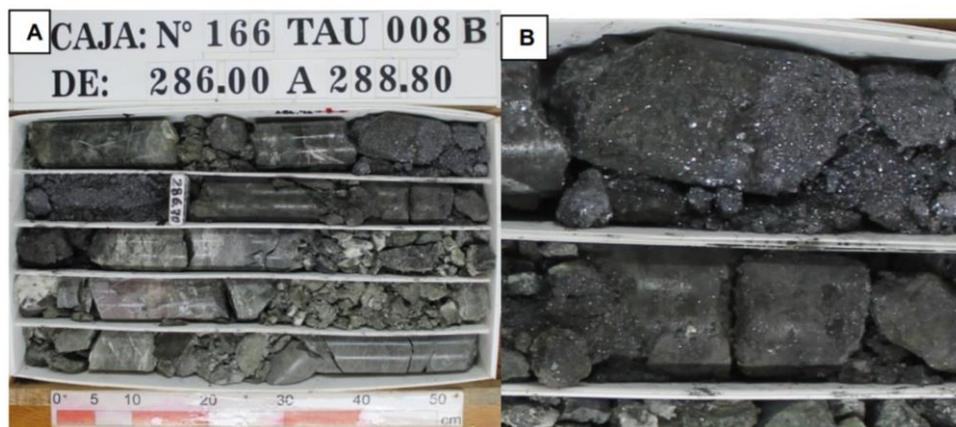
**Figura 27. A:** Sondaje TAU008B, se muestra uno de los tramos mineralizados. **B:** Detalle de la mineralización masiva de galena argentífera.
