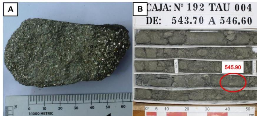
**Figura 55.** Muestra N° 7 para análisis SEM. **A:** Muestra de mano. **B:** Metraje perforado de donde se obtuvo la muestra.
