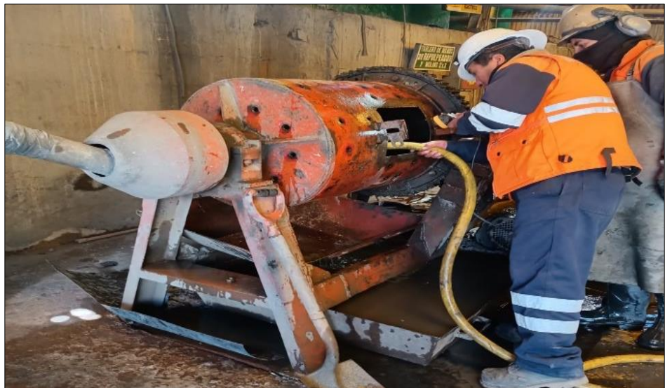
Figura 23. Desenchquetado del molino de bolas 2x3" implementado
