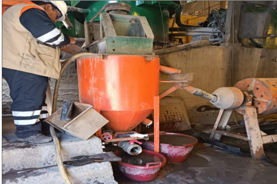
Figura 22. Descarga de repulpeador cónico implementado
