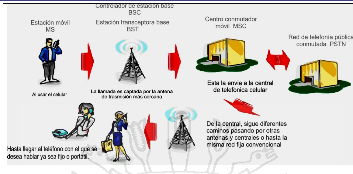
Figura Nº 19: Funcionamiento de la red móvil.
