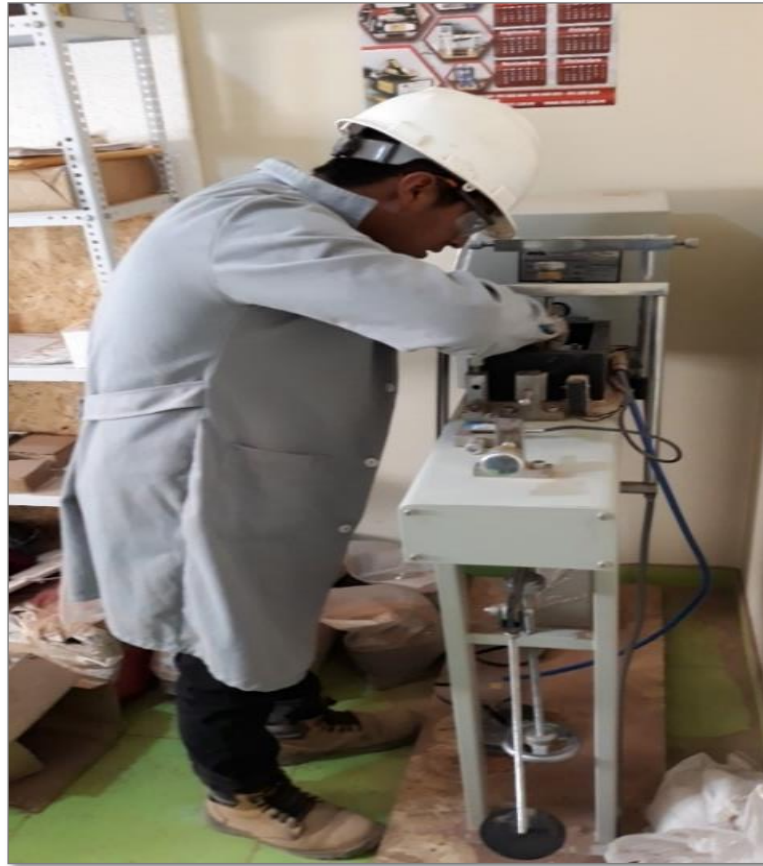
Figura 50 Colocación de la muestra en la Máquina De Corte Directo para el Ensayo De Corte Directo.
