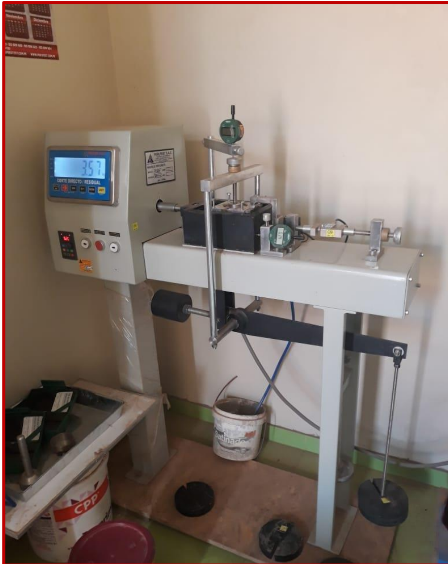
Figura 47 El equipo para el ensayo de corte directo.
