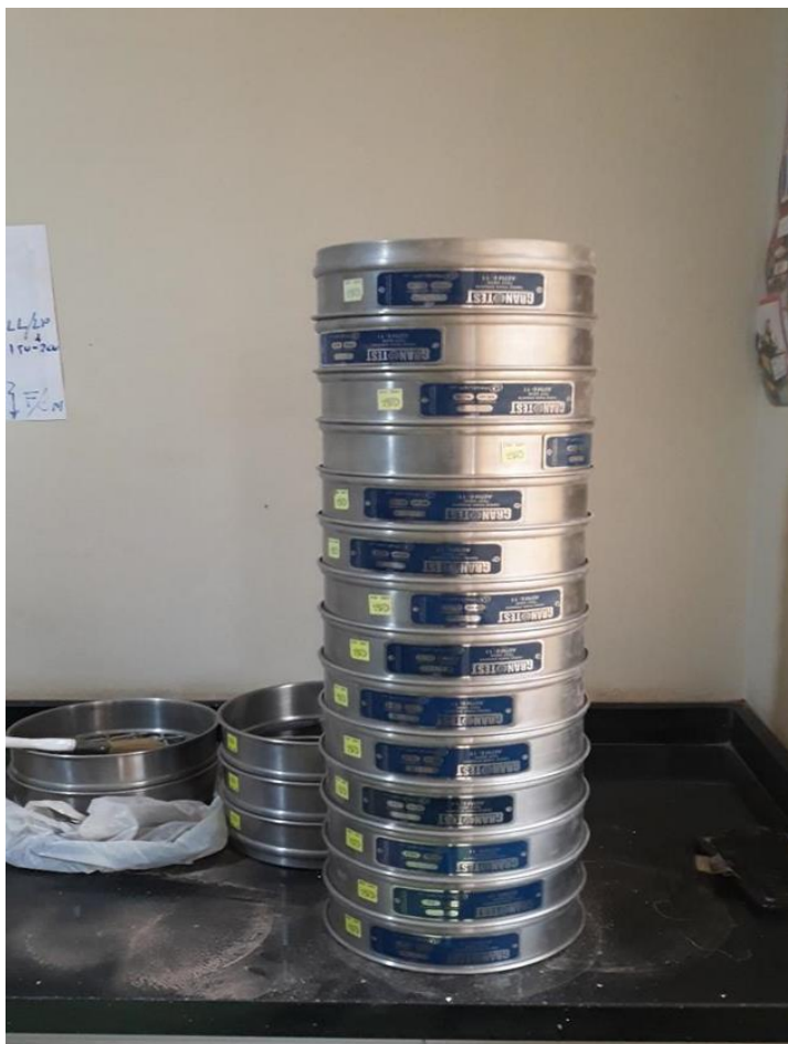
Figura 6 Se observan las mallas para los ensayos de laboratorio.
