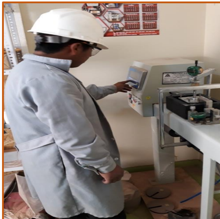
Figura 51 Equipo listo para El Ensayo De Corte. Peso 0.5 Kg.
