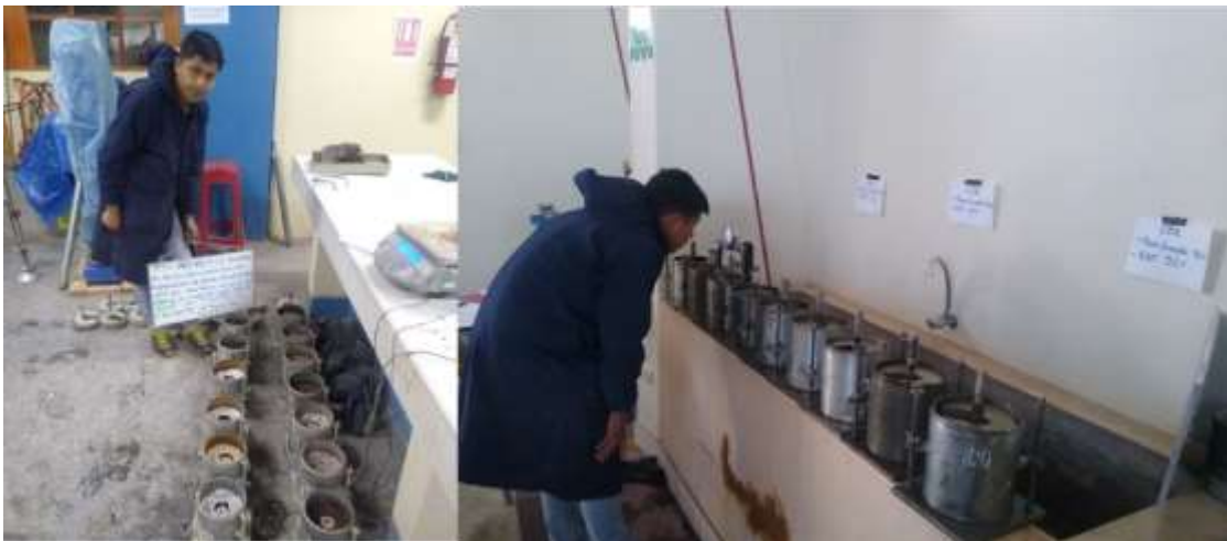
Fotografía 09: Ensayo de CBR para base granular añadido con RAP.
