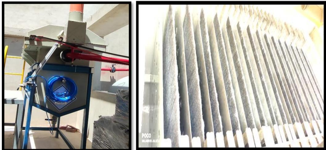
**Figura 36.** Celda Electrolítica con lana de acero, 16 ánodos y 15 cátodos
