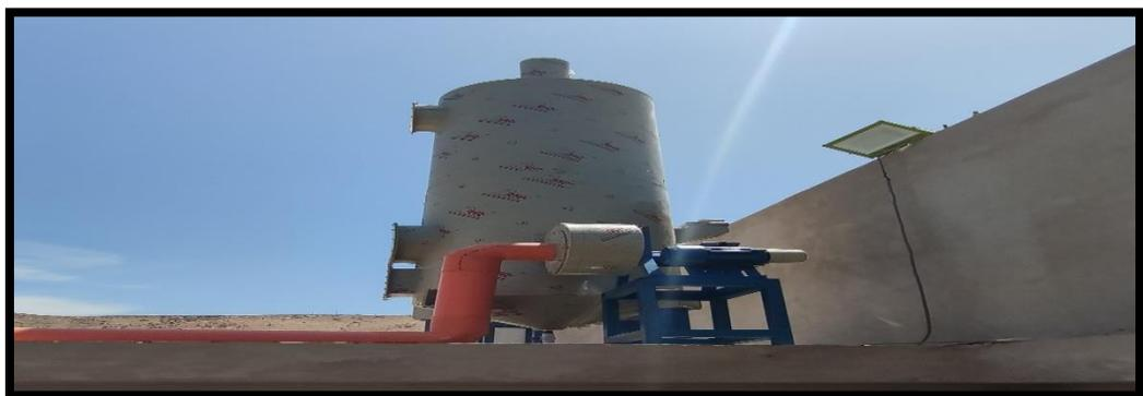
**Figura 37.** Extractor para recuperar vapor de solución de gases nocivos
