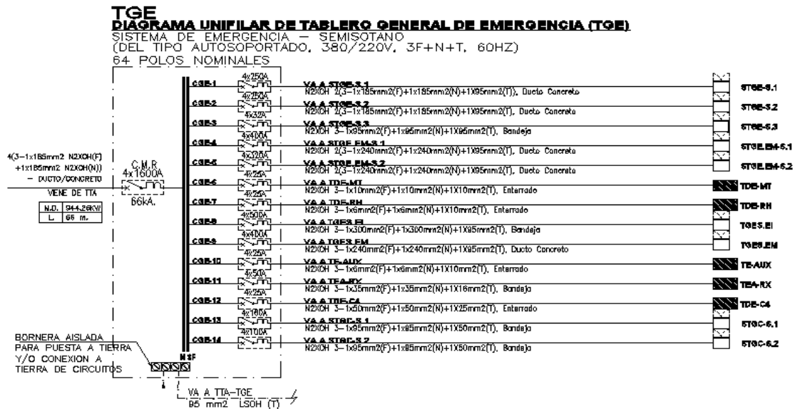
Figura 49: Diagrama unifilar del tablero TGE
