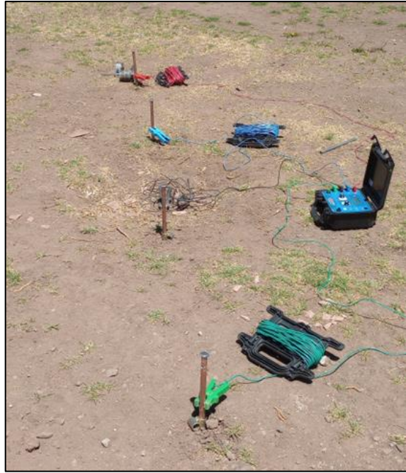
Figura 34: Instalación de jabalinas trayectoria N°2. Elaboración propia.
