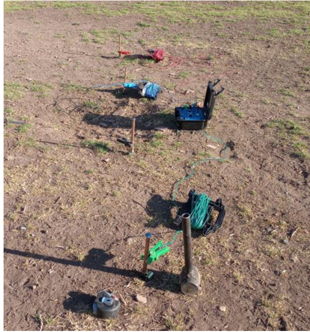
Figura 37: Instalación de jabalinas trayectoria N°3. Elaboración propia.
