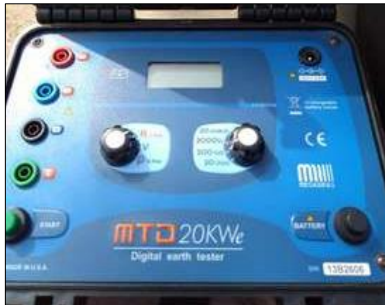
Figura 19: Telurómetro MEGABRAS Modelo MTD-20KWe. Fuente: MEGABRAS MTD-20KWe.
