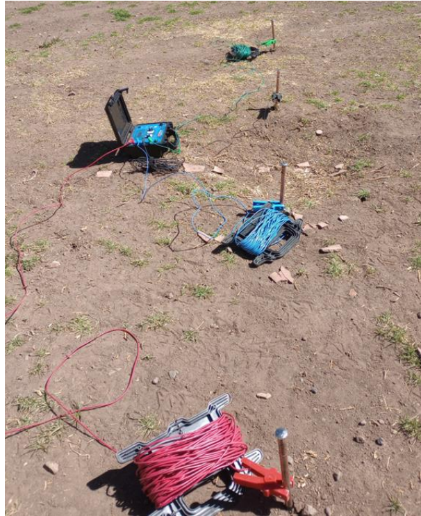
Figura 40: Instalación de jabalinas trayectoria N°4. Elaboración propia.
