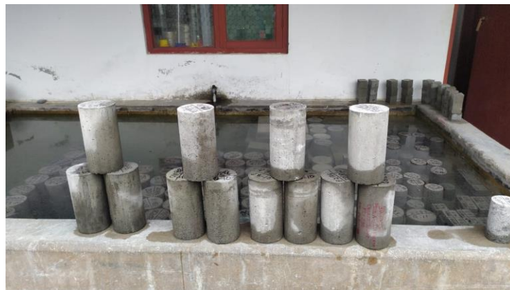
Figura 25. Testigos para el ensayo a la compresión
