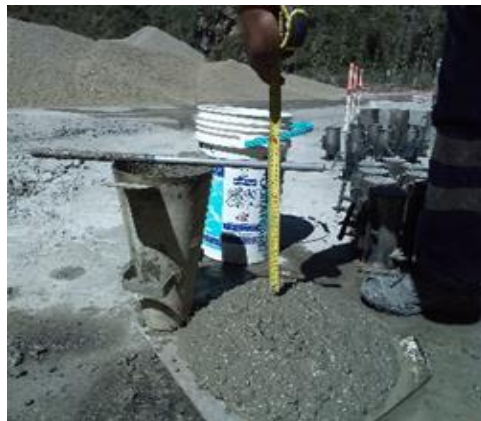
Figura 18. Mezcla de concreto (0.35% - 1.3%) asentamiento 9 ½”
