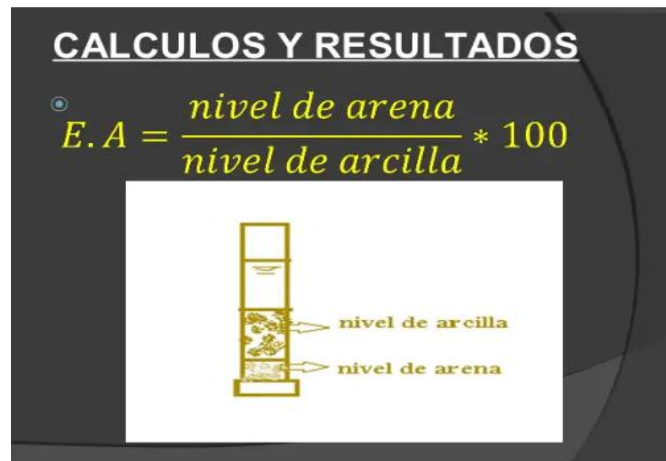
Figura 3. Ensayo de equivalente de arena
