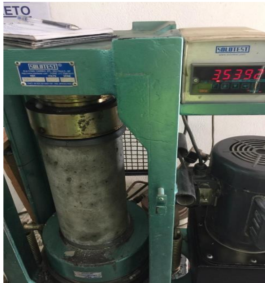
Figura 24. Ensayo a la compresion (ASTM C-39)
