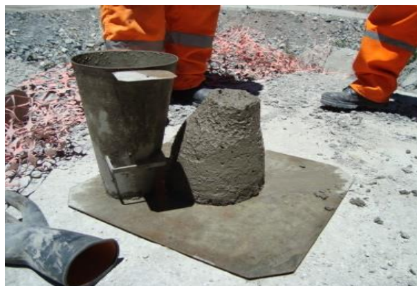
Figura. 11. Asentamiento a 2 horas
