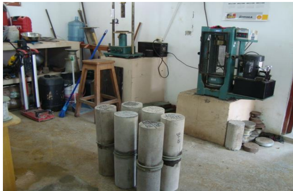
Figura 29. Ensayo a la compresion (ASTM C-39)
