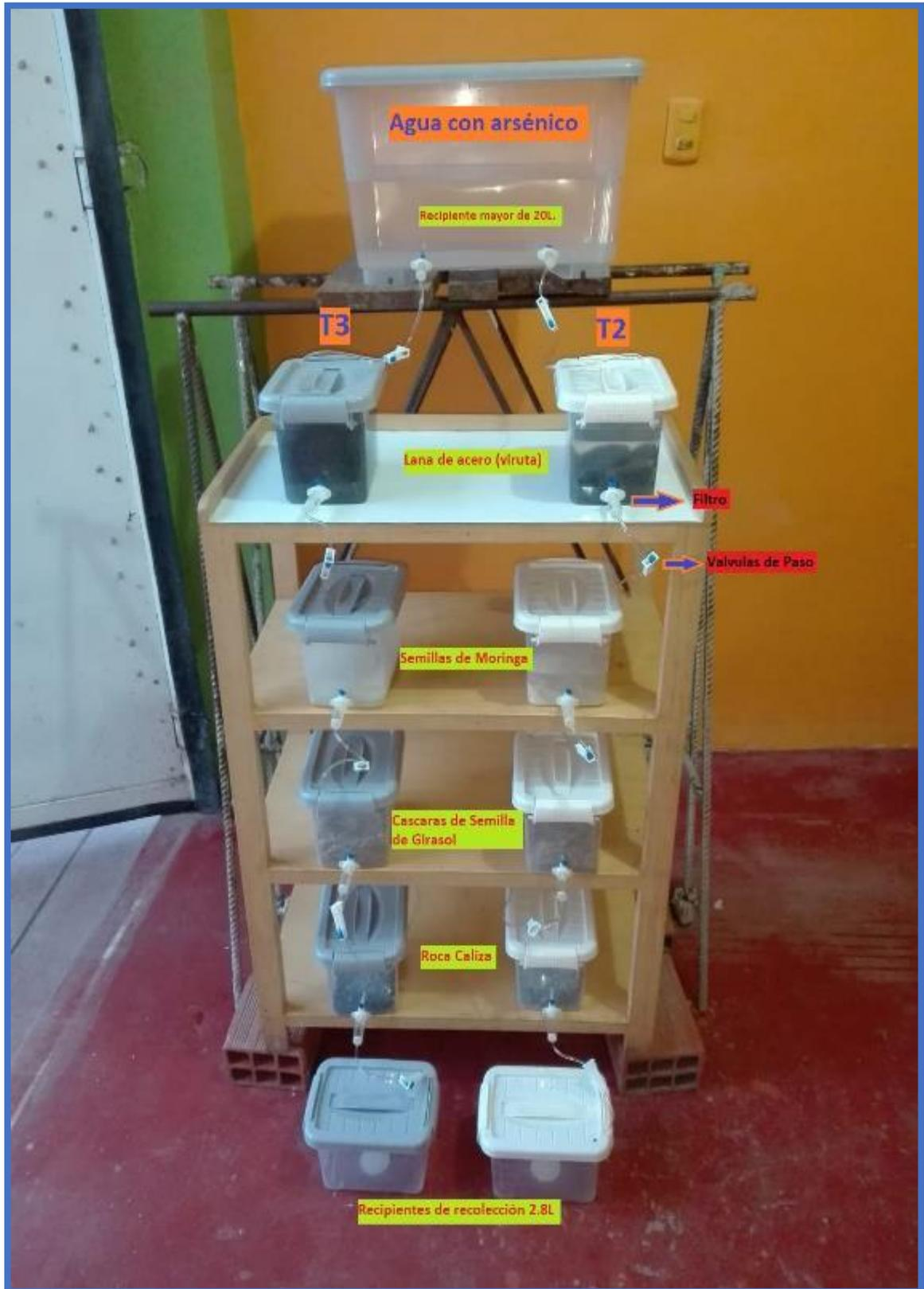
Figura 12. Planta de tratamiento con sus respectivas etapas.
