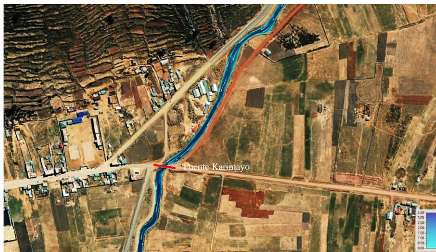
Figura 21: Modelamiento hidráulico 2D (TR 2 años) – puente Karimayo.
