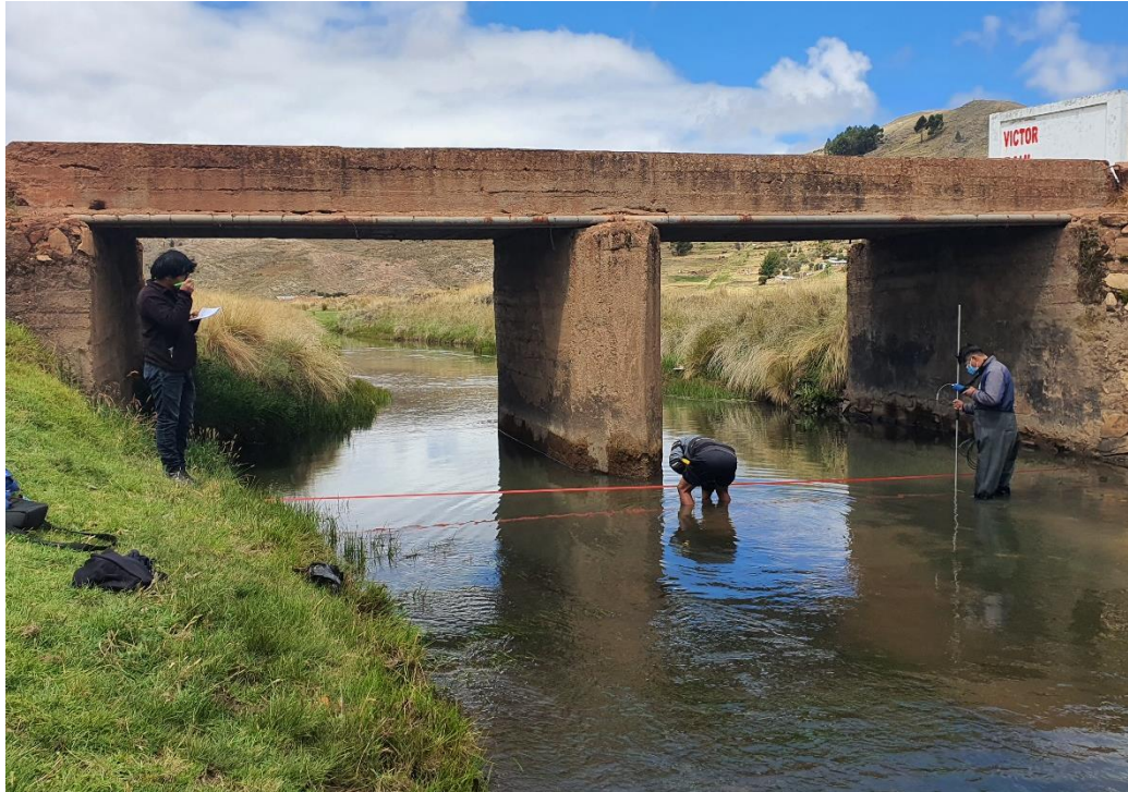
Figura 12. Proceso de calibración del modelo hidráulico mediante aforos.
