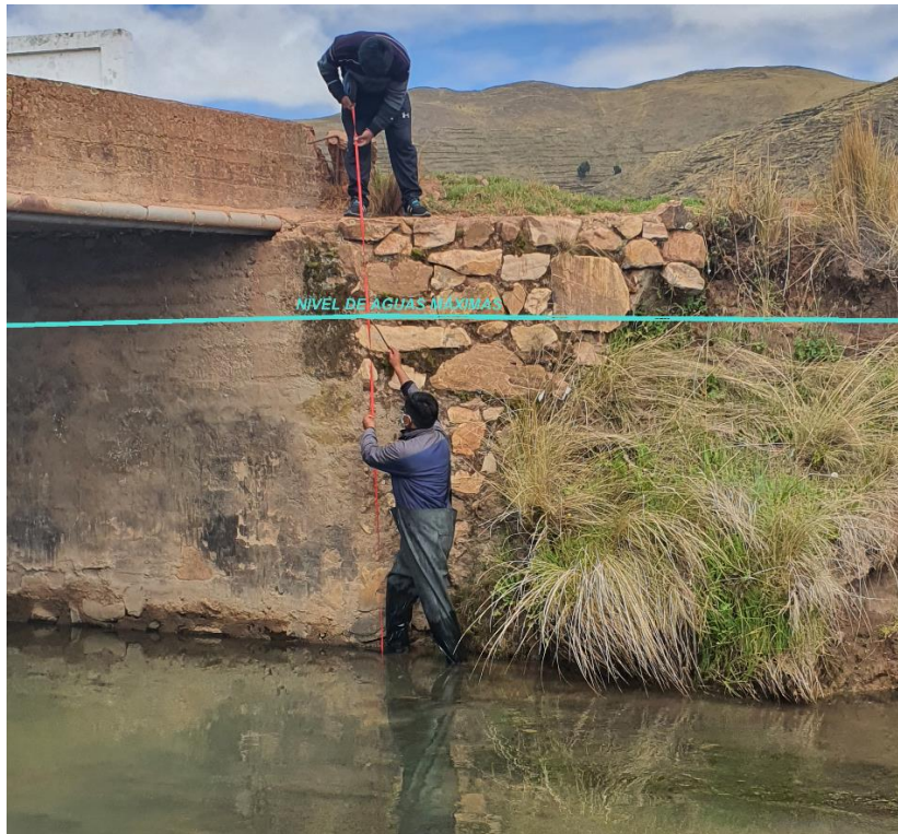
Figura 13. Medición de marcas de eventos pasados para la validación del modelo
