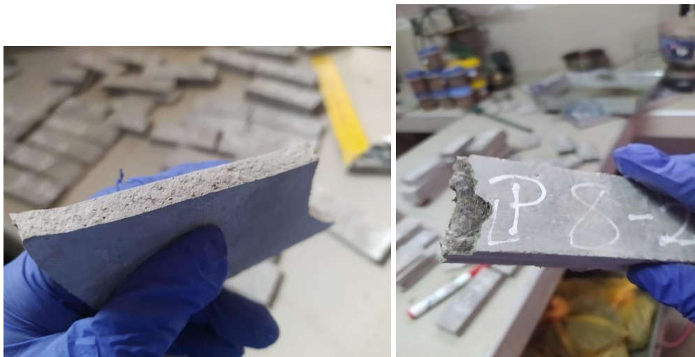
Figura C. 11. Ensayo de resistencia a la flexión – Rotura de especímenes
