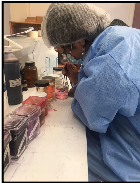
FOTO N° 13: COLOCACION DE BALSAMO DE CANADA.
