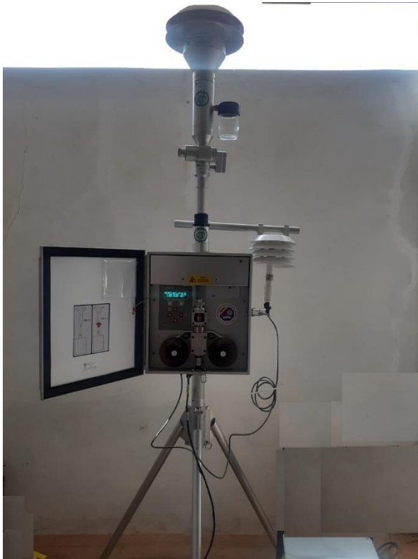
Figura 4. Monitor de atenuación beta para medición de PM_{10} y PM_{2.5} .
