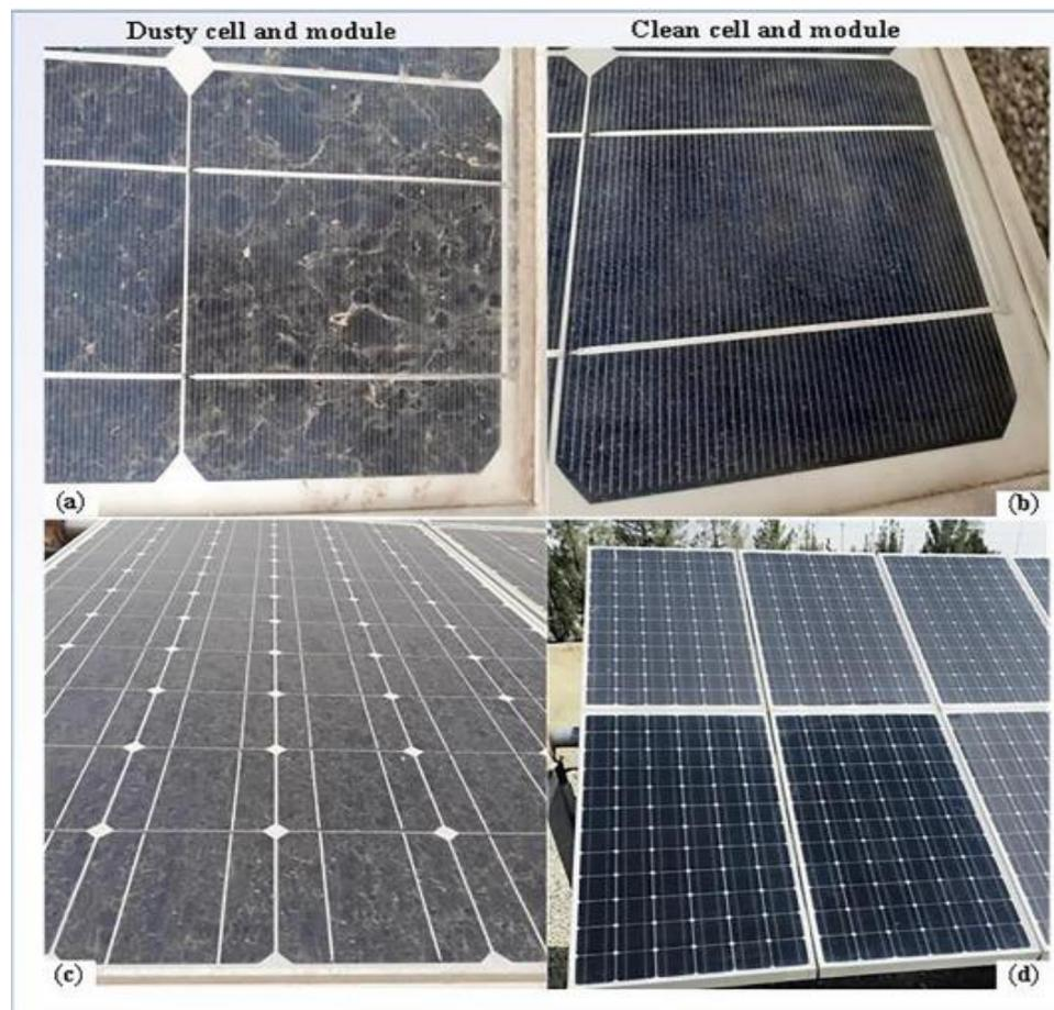
**Figura 8:** Acumulación de polvo en la superficie del panel solar con efectos de lluvia parcial
