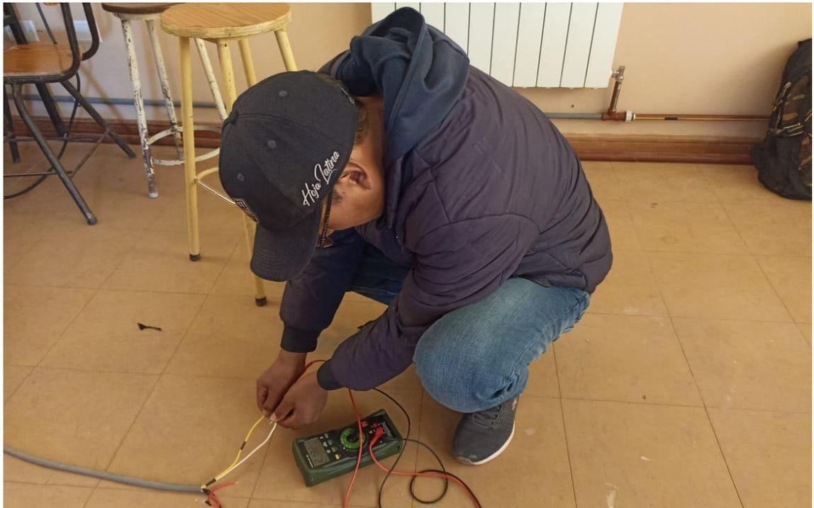
Medición de la tensión de salida del panel solar fotovoltaico de 21.30 v.
