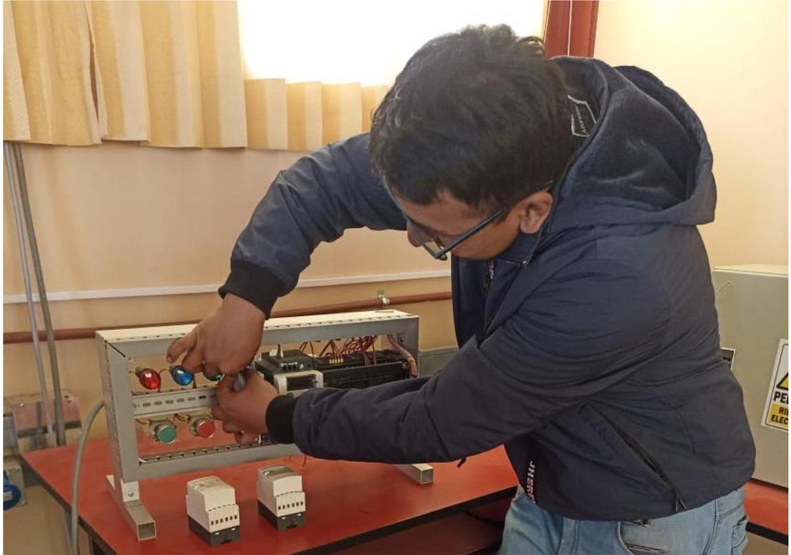
Instalación del PLC, Modicon M241, Schneider Electric y los sensores de Corriente.
