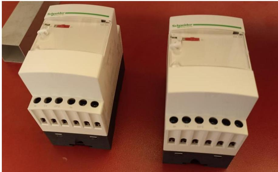
**Figura 14:** Conversor (sensor) de corriente a tensión, Schneider Electric
