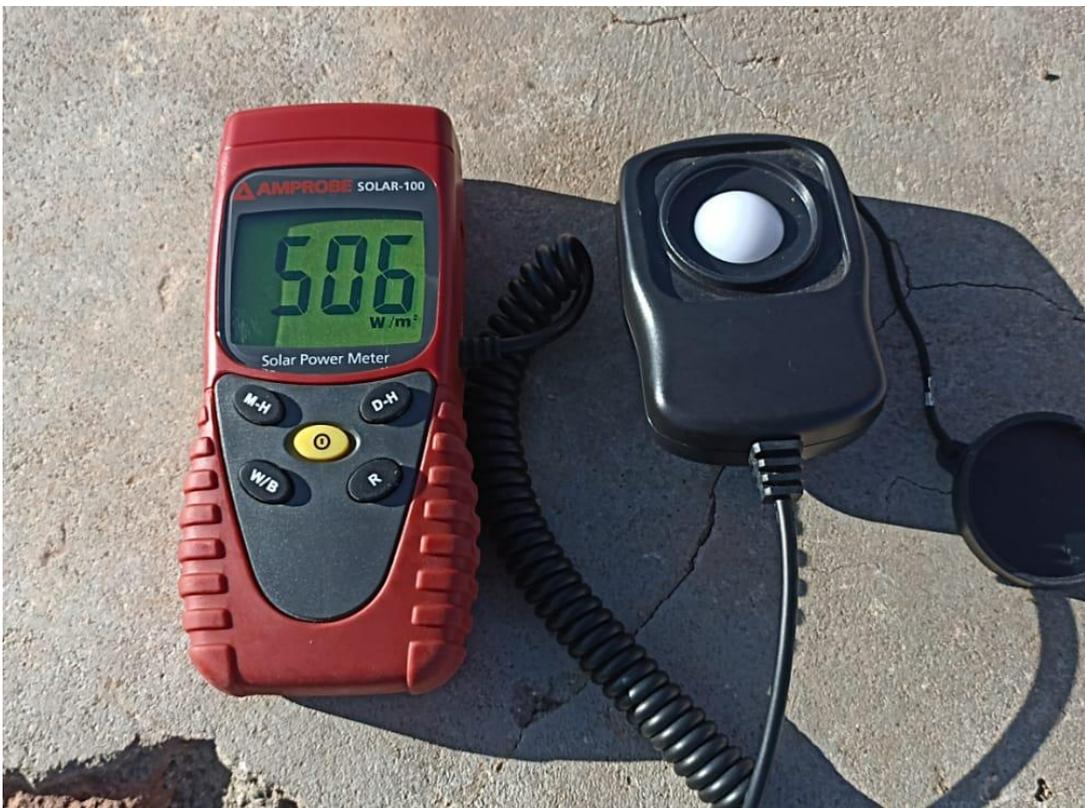
Solarímetro Amprobe solar 100 – USA, en un día soleado.
