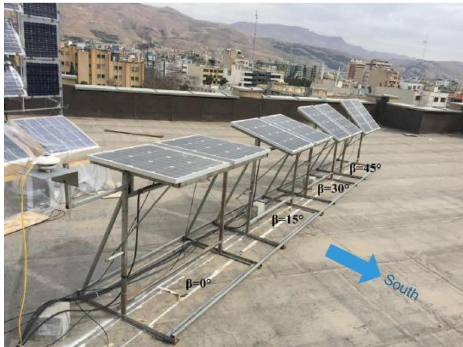
**Figura 9:** Acumulación de polvo a diferentes ángulos de inclinación del panel solar
