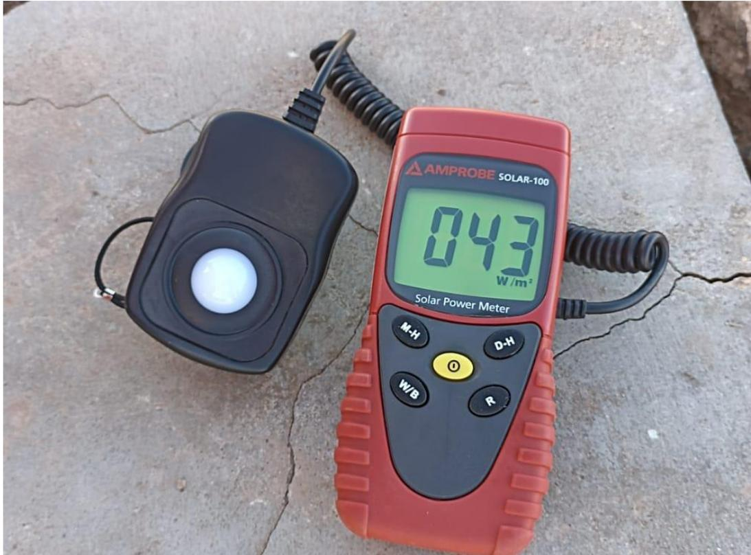
Medidor solar: Amprobe Solar 100 – USA, día nublado.
