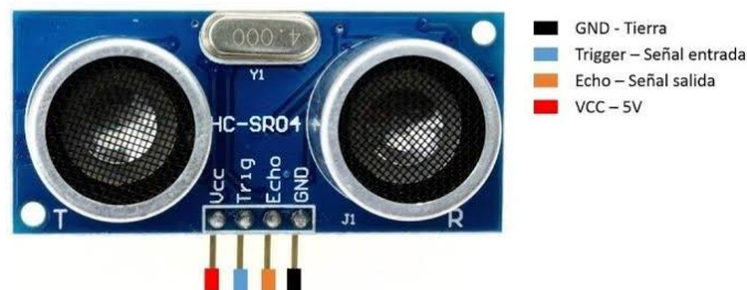
Figura 13: Pines de sensor ultrasónico HC-SR04.
