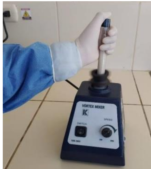
Agitar los tubos de ensayo en un mixer tipo Vortex
