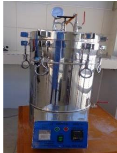
Esterilización en autoclave a 121°C
