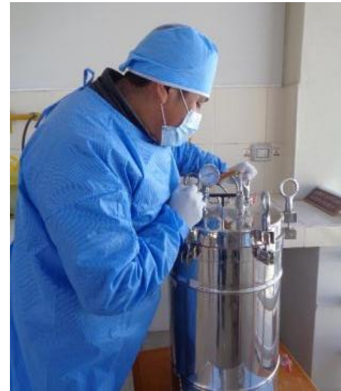
Cerrado de autoclave para su esterilización a 120°C
