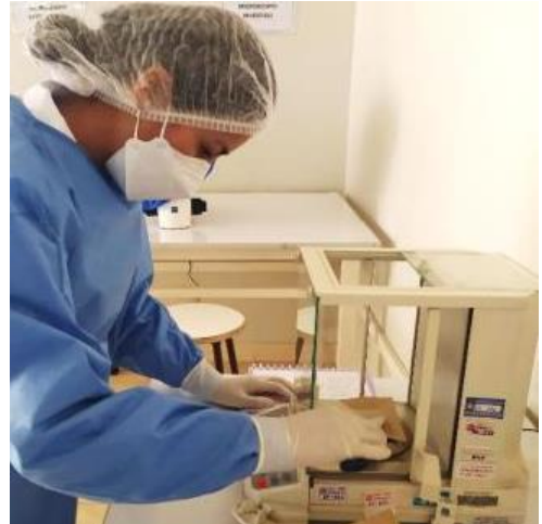
Pesado en balanza analítica de la arcilla de hidralgirita ( CHAQO )
