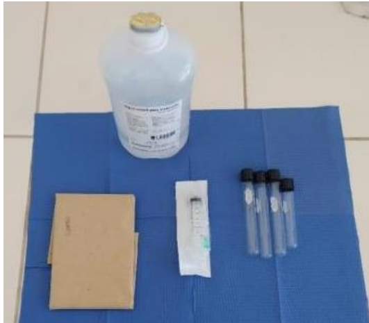
Arcilla de hidralgirita ( CHAQO ), Agua bidestilada, Jeringa de 10 ml y tubos de ensayo con tapa roscas
