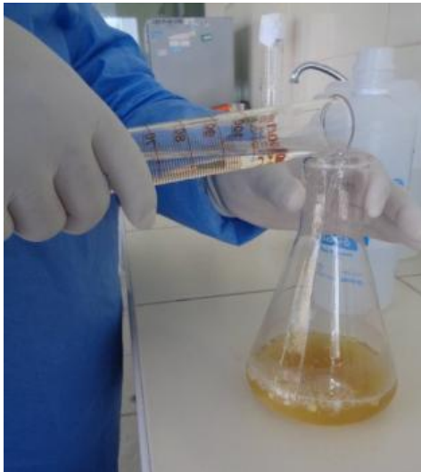
Colocación de agua destilada en el Matraz de Erlenmeyer
