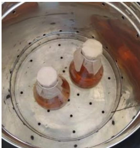
Colocación de los matraces en autoclave
