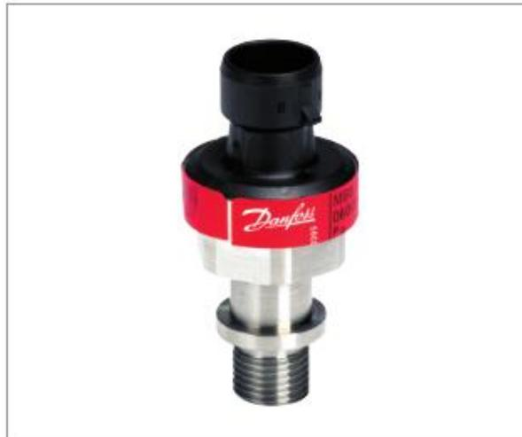
La gama de transmisores de presión MBS 1900 ha sido diseñada para su uso en aplicaciones con aire y agua, como bombas de tipo booster y compresores de aire. Esta gama de transmisores de presión, de carácter semiflexible, abarca diferentes señales de salida y está disponible en versiones absoluta y relativa, con rangos de medición comprendidos entre 0 – 4 bar y 0 – 25 bar y un amplio abanico de conexiones de presión y eléctricas. La carcasa está fabricada en acero inoxidable AISI 316L.
