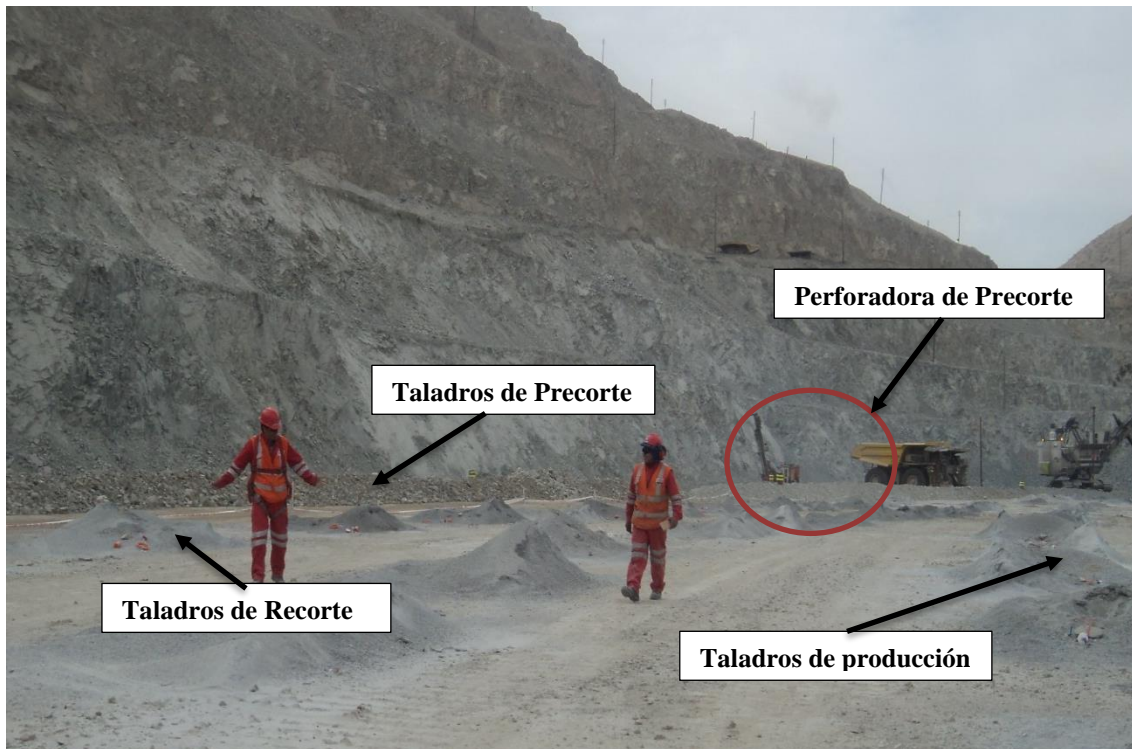
Figura 22. Vista en campo de la malla conjunta.
