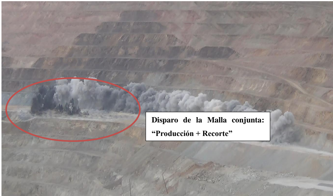
Figura 26. Disparo de malla conjunta después del precorte en fase 5.
