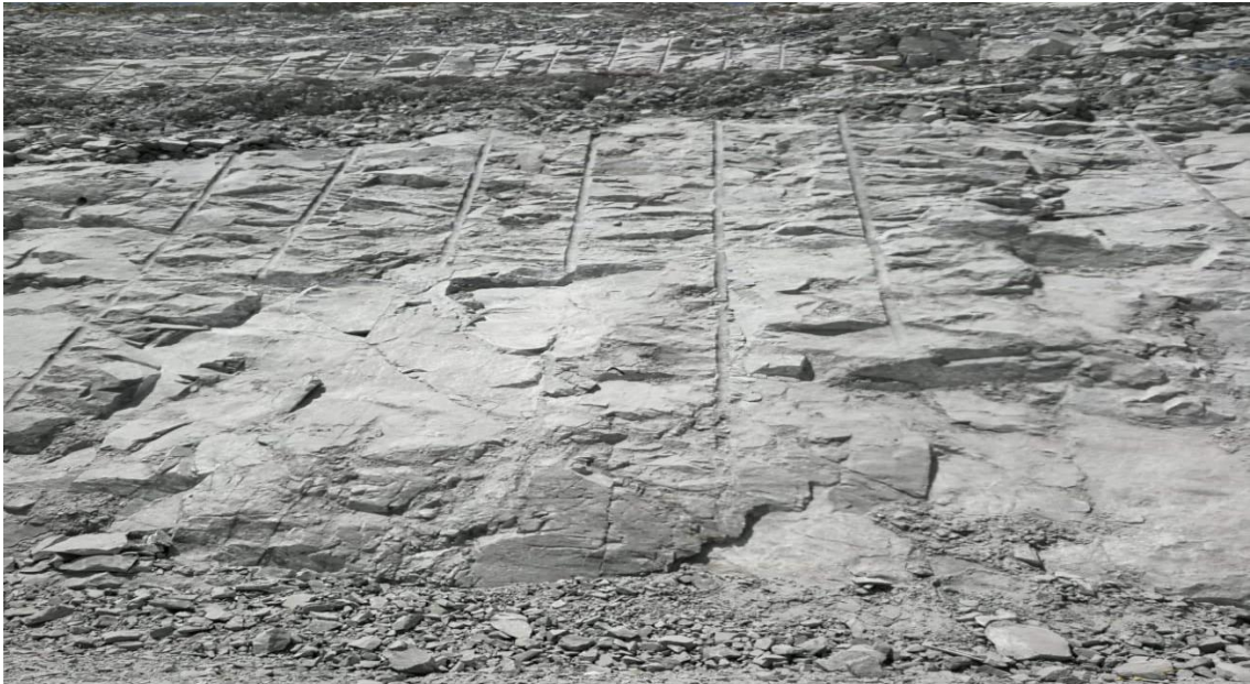
Figura 29. Vista de las paredes de banco del disparo 2905 – 127 y 128 con voladura controlada.
