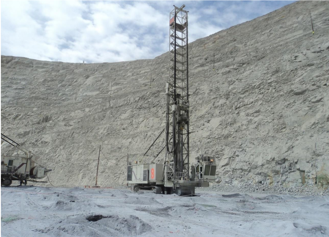
Figura 20. Perforadora N° 8 en los taladros de recorte.
