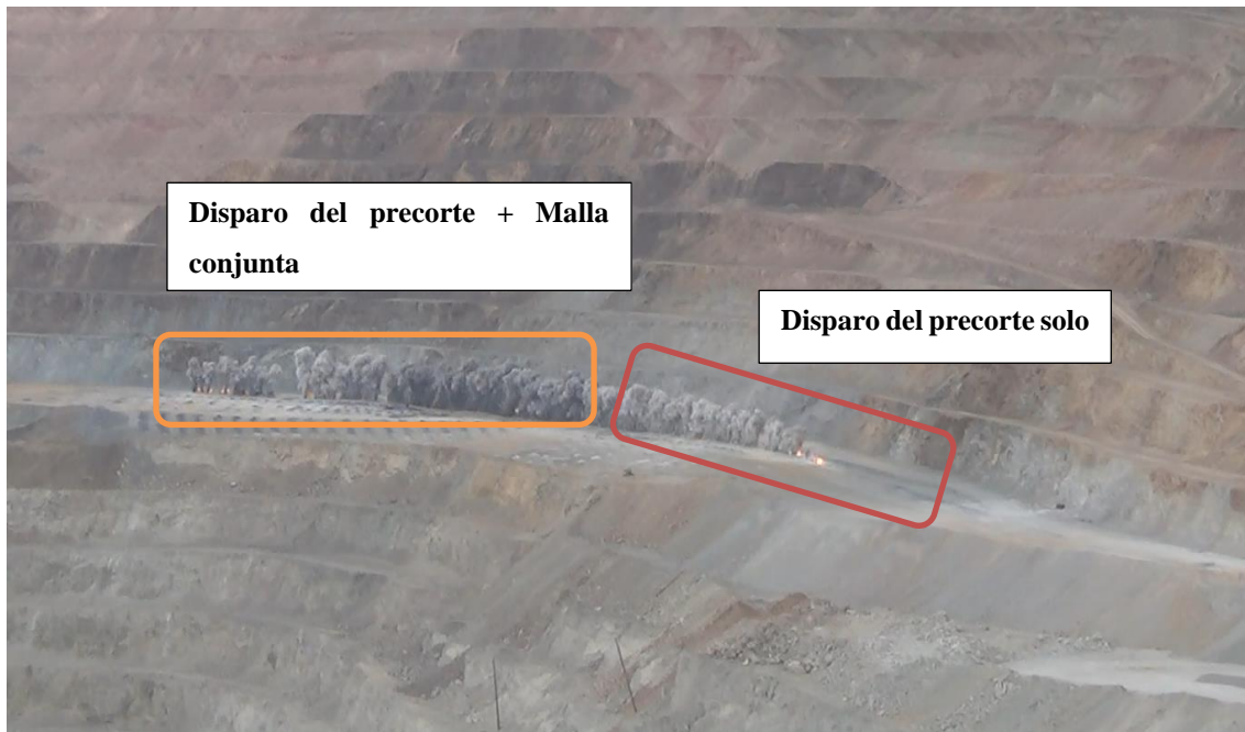
Figura 25. Disparo del precorte en fase 5 de la mina Toquepala.
