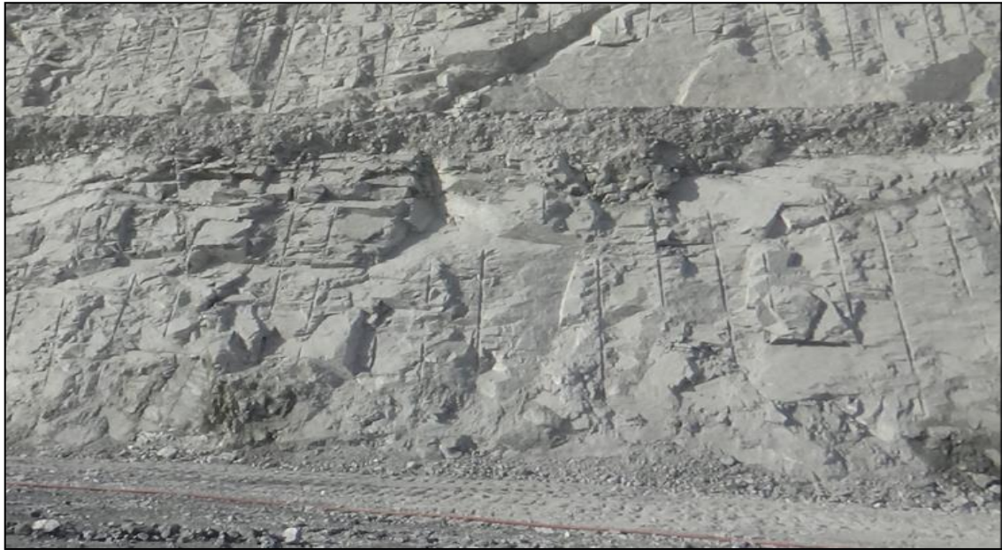
Figura 35. Vista de las paredes de banco del disparo 3235 – 201 y 207 con voladura controlada.
