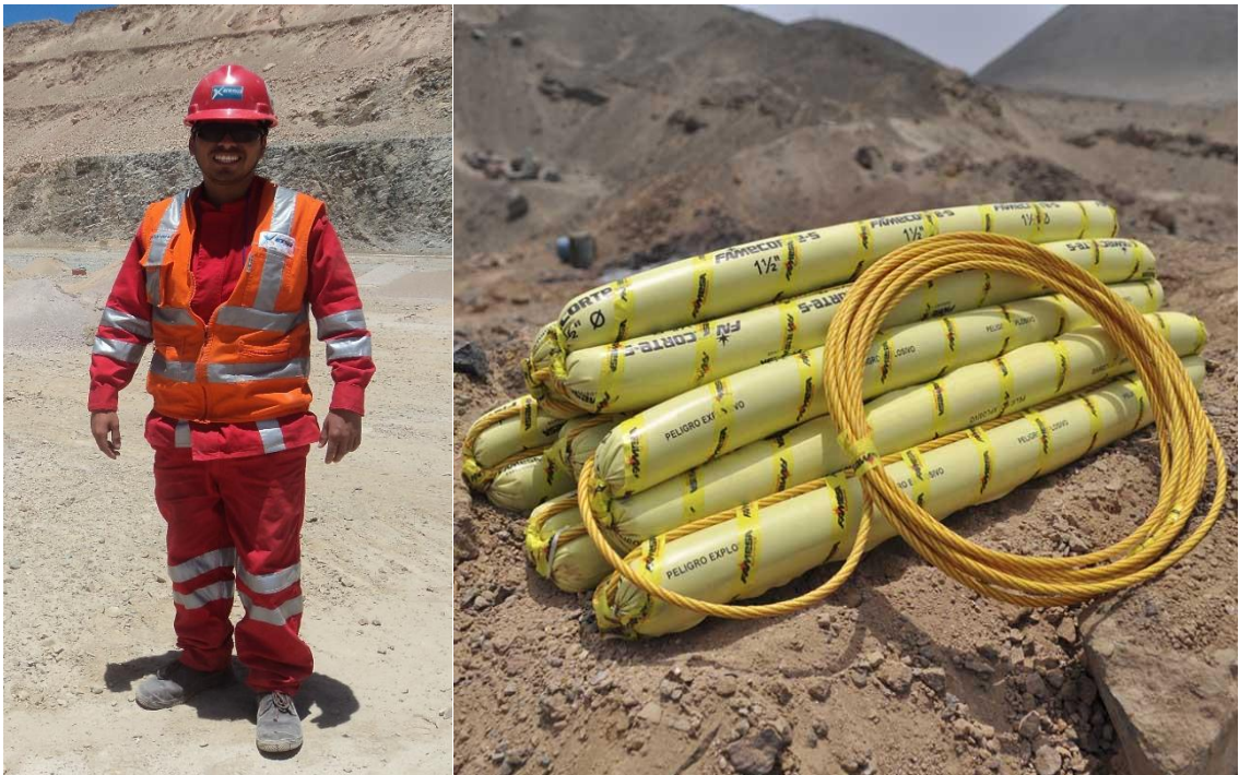
Figura 24. Carguío de los taladros de precorte con el explosivo Famecorte.
