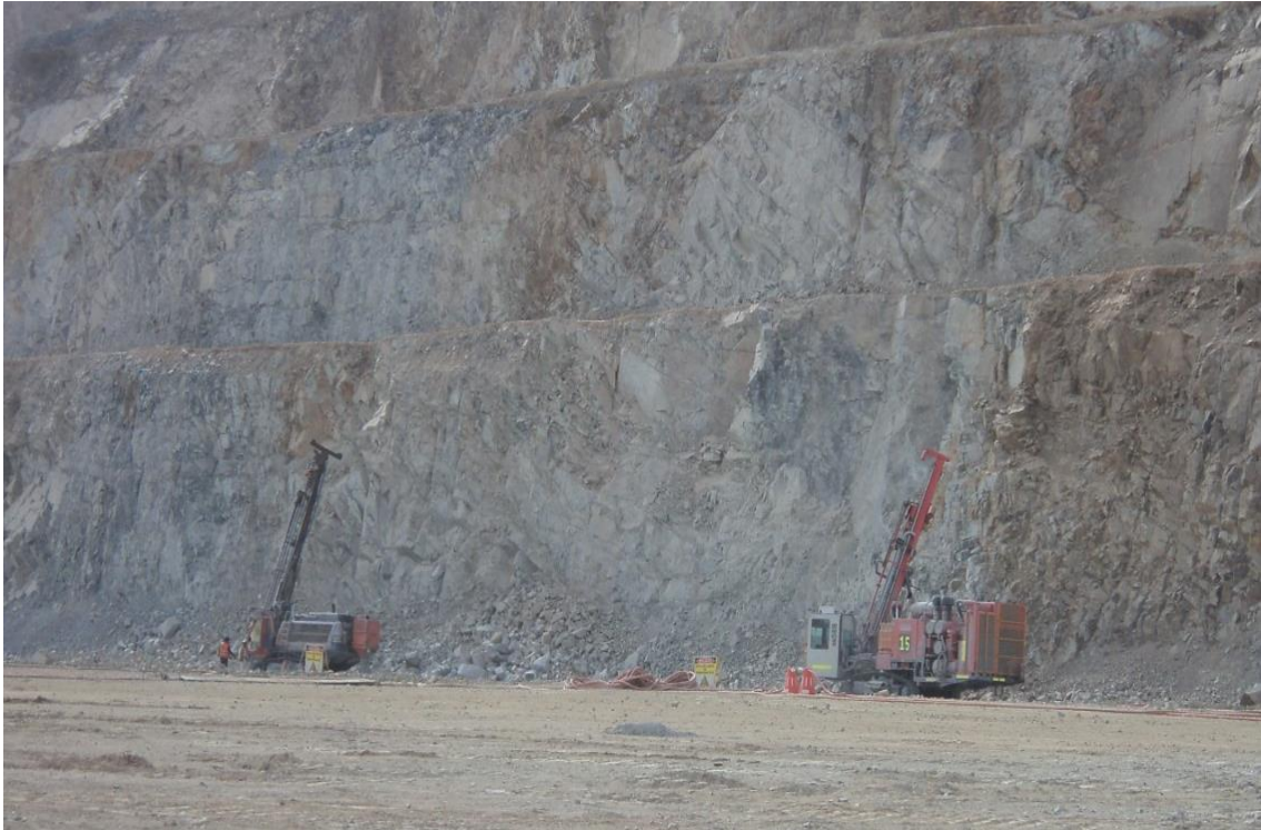
Figura 21. Perforadoras N° 14 y 15 en los taladros de precorte.
