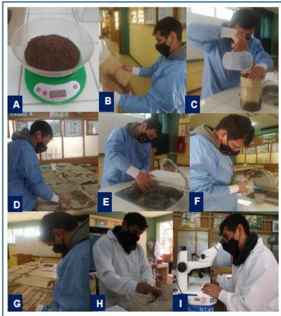
**Figura 11.** Método rápido de extracción de quistes del suelo seco adaptado a laboratorio. (A: Pesar 250 cm<sup>3</sup> de suelo, B: Introducir 125 cm<sup>3</sup> al vaso Becker, C: Agregar agua y dejar reposar, D: extender y codificar, E: Vertido del sobrenadante en tamices 60 y 100 Mesh respectivamente, F: Recolectar 30 – 50 ml del sobrenadante, G: Esparcir en forma lineal y codificar, H: Retirar con un pincel el material seco a una placa Petri y I: Cuantificación de quistes).
