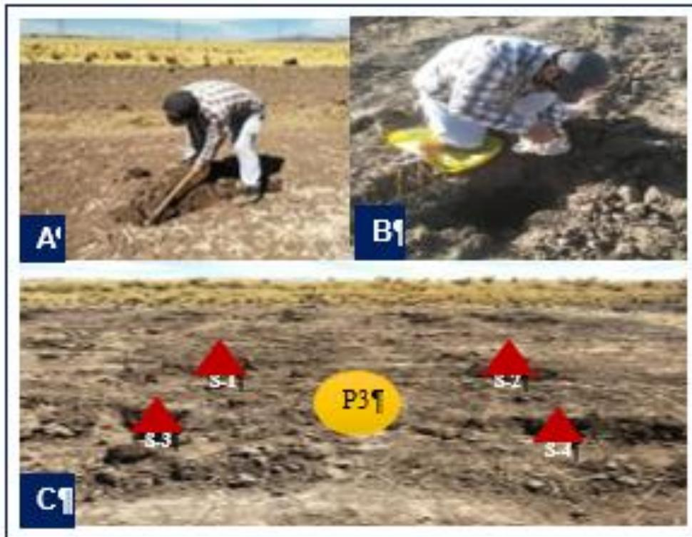
**Figura 9.** Recolecta de muestra de suelo: (A: Realizar un excavado de 25 cm de profundidad, B: Recolectar 500 cm<sup>3</sup> de muestra y C: Punto de recolección de submuestra (S-1) y punto (P3).
