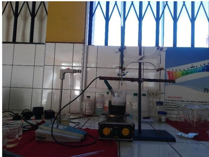
**Figura 15.** *Proceso de neutralización de Agua ácida de mina*
