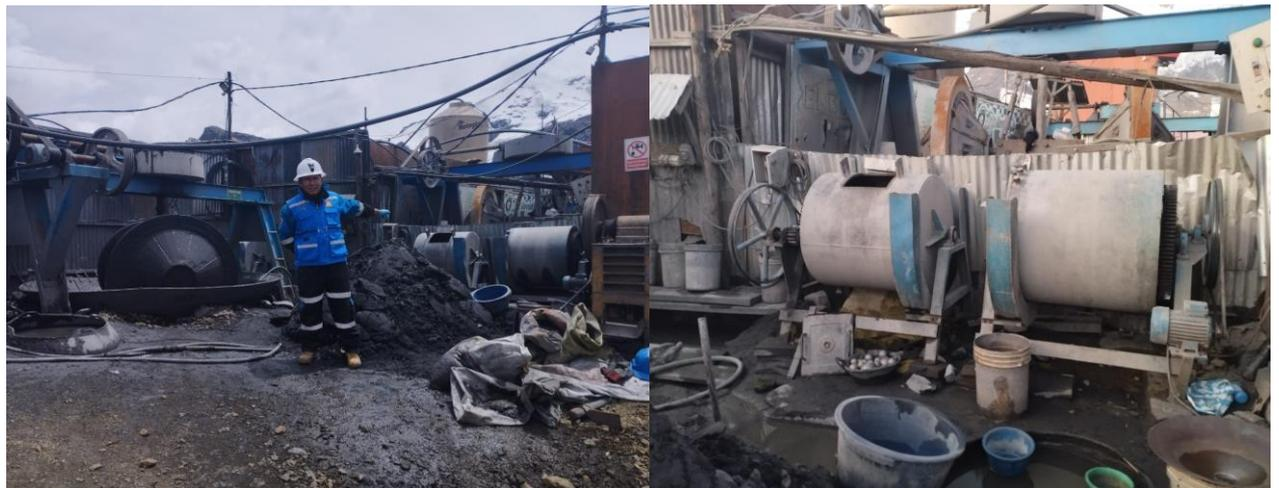
Figura B-11: Amalgamación del concentrado en molino
