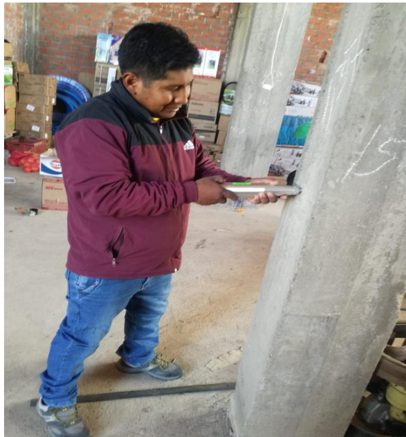
Figura 15: Medición de la resistencia del concreto en columnas de la vivienda V-19 Fuente: Elaborado por el equipo de trabajo en la fecha 09/05/2022
