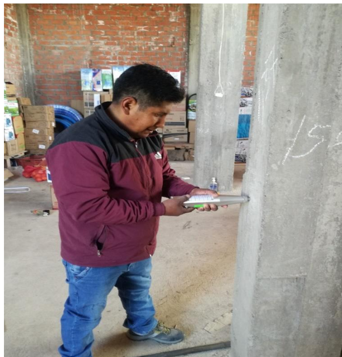
Figura A. 10 Medición de la resistencia del concreto en columnas en la vivienda V-52, realizado en la fecha 09/05/22
