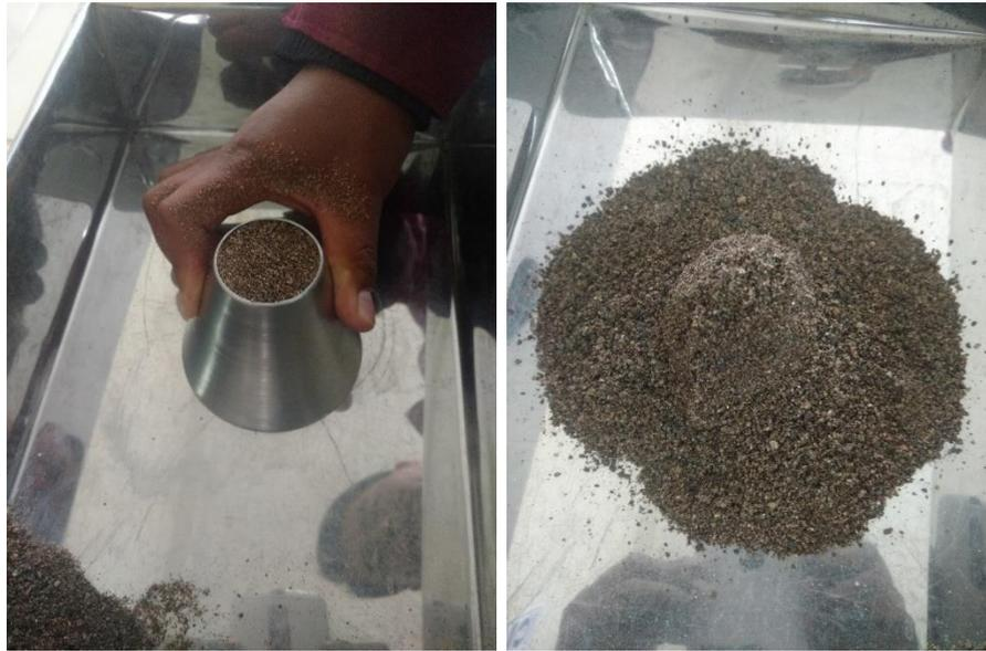
Inmediatamente después se pesa 500gr, para los ensayos de peso específico y otros 500gr para los ensayos de absorción, este último se lleva al horno para que se obtenga su peso seco.
