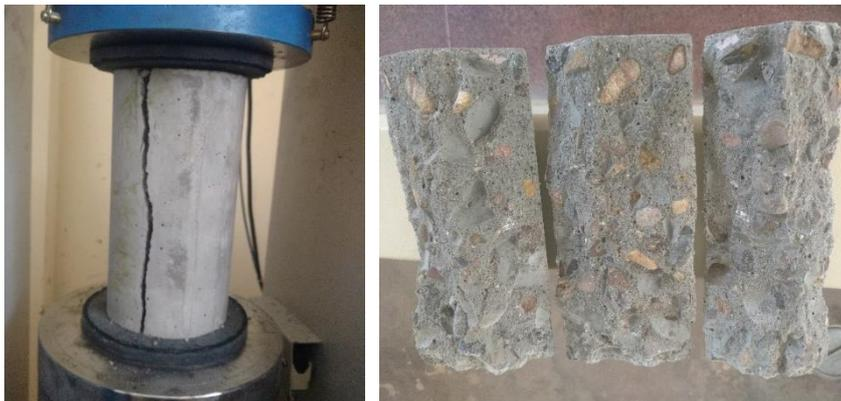
**Figura 46:** Tipos de fractura de probetas
