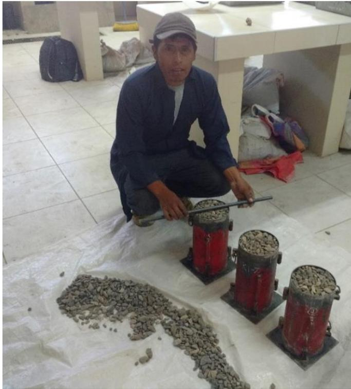
**Figura 40:** *Enrazado del agregado*
