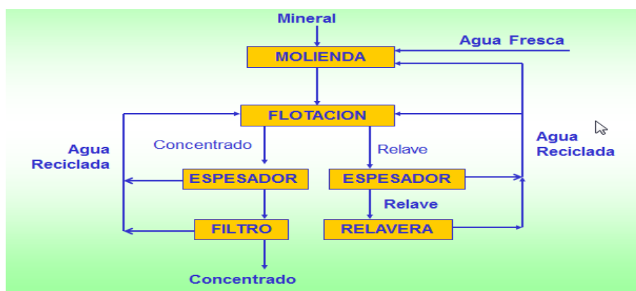
FIGURA 13 PLANTA CONCENTRADORA CON RECICLAJE DE AGUA
