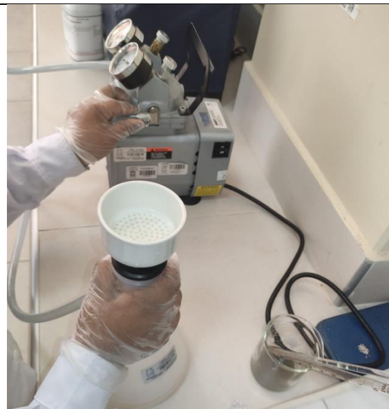
Fotografía N° 22 Filtrado de muestras de aguas residuales con bomba de vacío.
