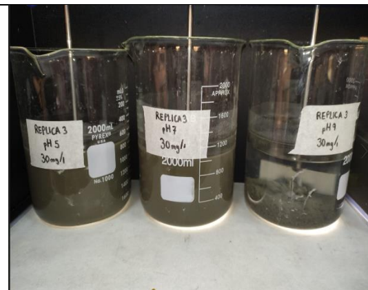
Fotografía N° 12 Sedimentación de sólidos en suspensión a dosificación con floculante SUPERFLOC A-110
