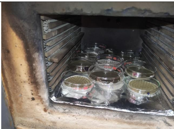
Fotografía N° 21 Secado de muestras en mufla a 105°C por un periodo de 1 hora
