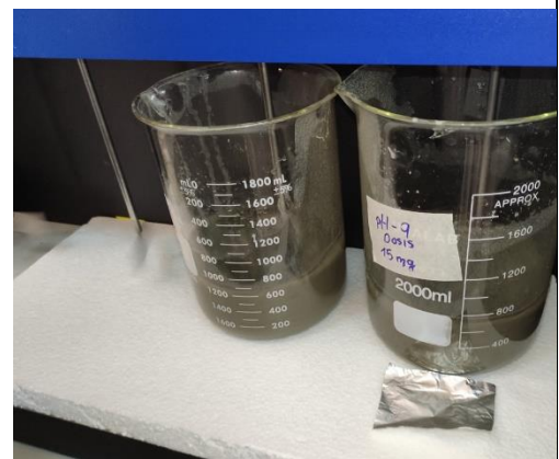
Fotografía N° 8 Pruebas de agitación lentas y rápida
