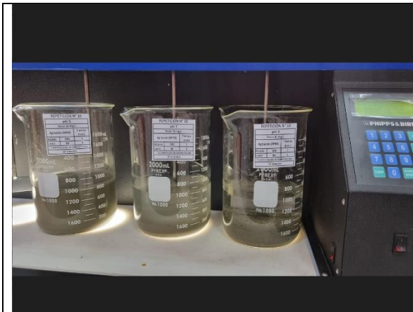
Fotografía N° 9 Pruebas de jarras repetición N° 10
