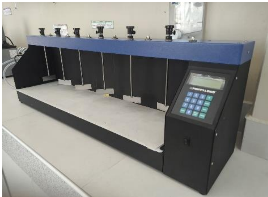
Figura 2. Equipo de prueba de jarras serie Phipps & Bird PB-900
