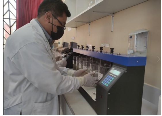
Fotografía N° 20 Operación de equipo de pruebas de jarras
