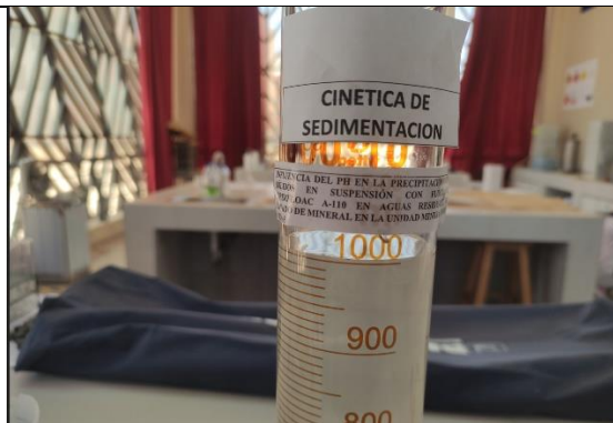
Fotografía N° 17 Determinación de velocidad de sedimentación de sólidos sedimentales.
