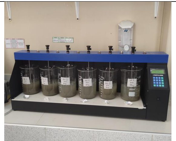
Fotografía N° 10 Pruebas de optimización de dosificación de coagulante
