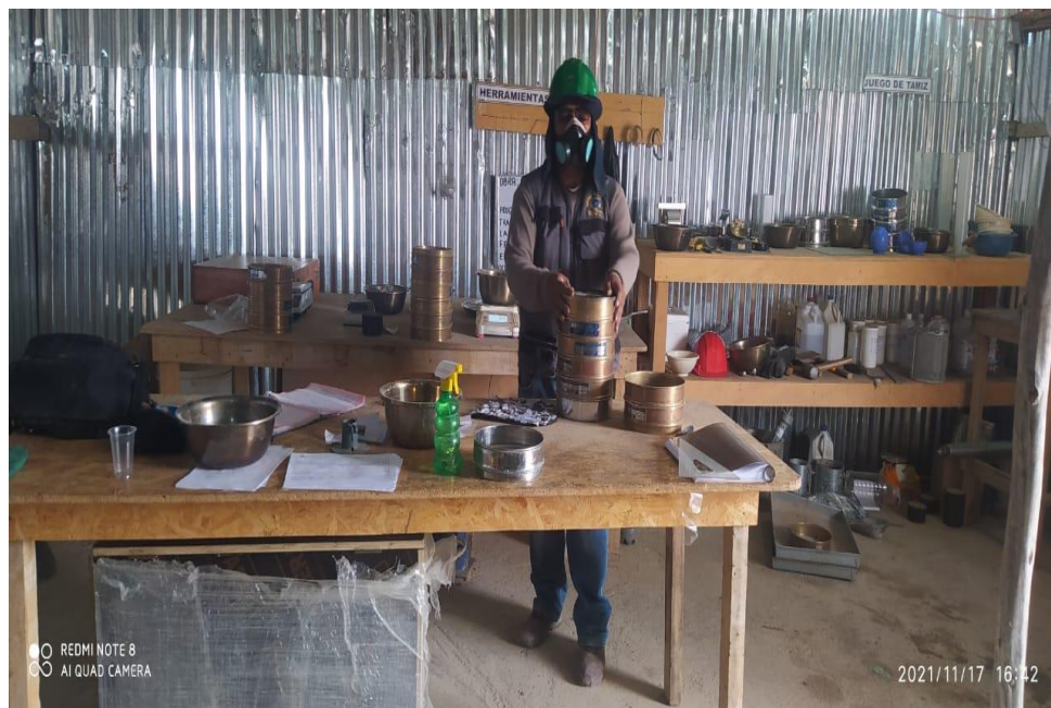
Fotografía 8: Se realiza los ensayos de análisis granulométrico por tamizado y demás ensayos para ambas canteras.
