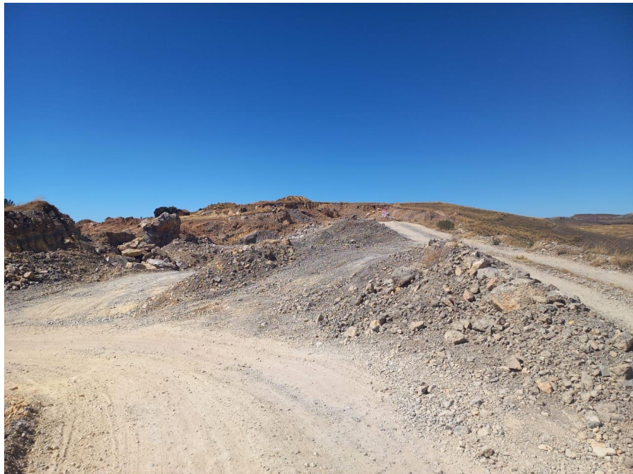
Fotografía 2: Se observa que el material de la cantera Chuaña está conformada por roca caliza y limos.
