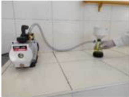
FILTRACION AL VACIO
