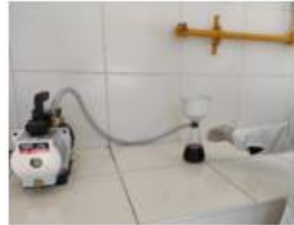
FILTRACION AL VACIO
