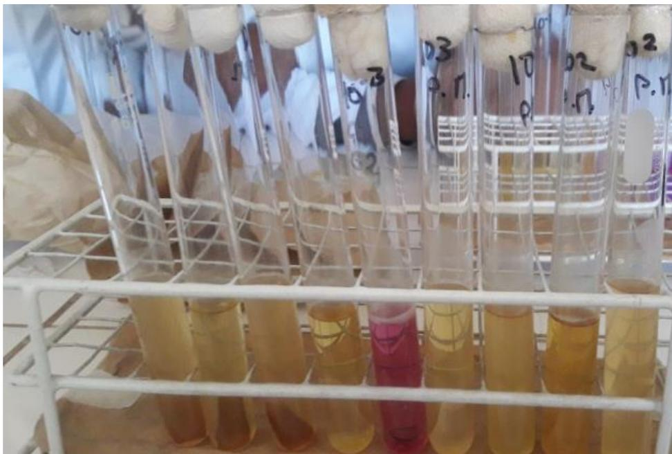
**Figura 6.** Caldo Lactosado para determinar coliformes totales y coliformes fecales
