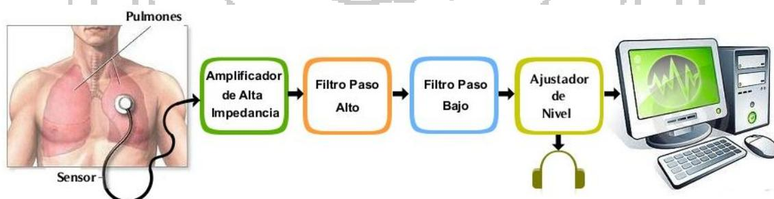
**Figura 24. Diagrama a bloques del circuito de adquisición de sonidos respiratorios**
