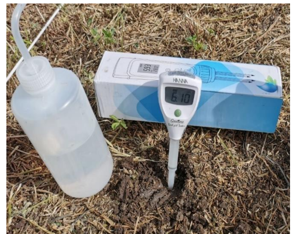
Figura 79. Medición de pH del suelo con pH metro HANNA (HI81030)
