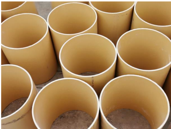
Figura 36. Corte de tubería PVC en cilindros de 30 cm
