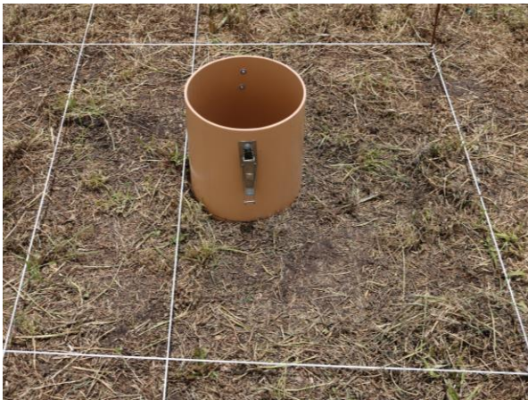
Figura 58. Cámara estática instalada en el centro de la parcela experimental
