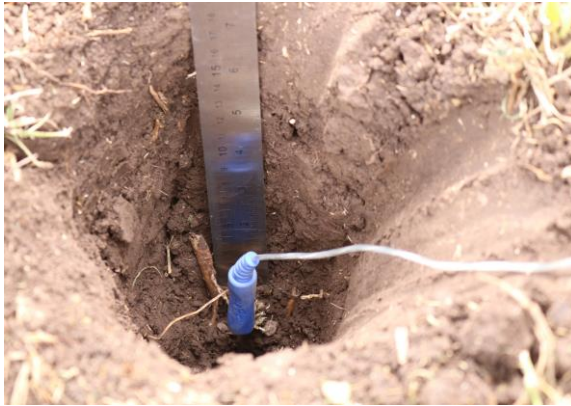
Figura 34. Instalación de la sonda de temperatura a 10 cm del suelo
