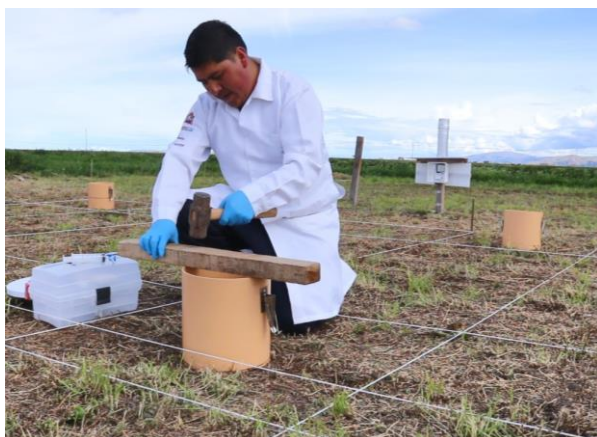
Figura 56. Inserción de la cámara estática a \geq 5 cm del suelo con ayuda de un combo
