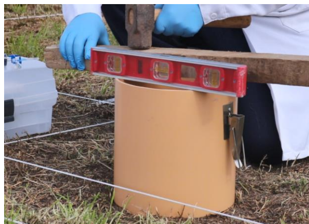
Figura 57. Nivelación de la cámara estática
