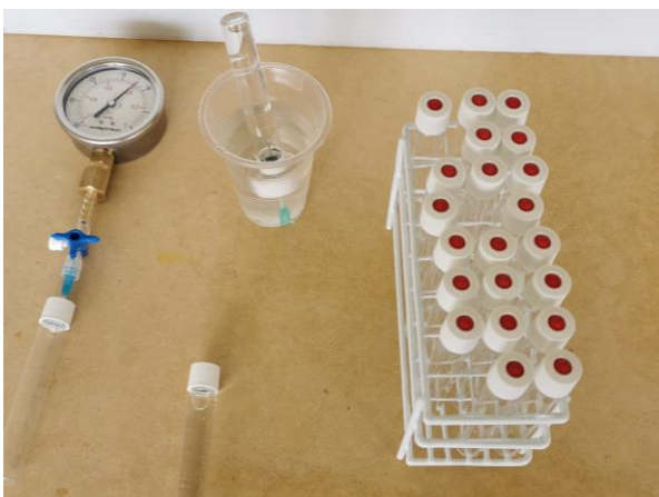
Figura 68. Demostración de vacío mediante la prueba de agua
