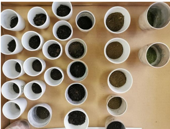
Figura 90. Crisoles cargados con muestras de suelo seco para determinar MO
