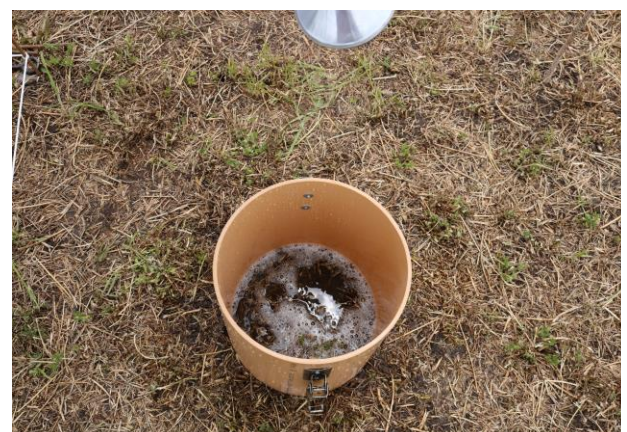
Figura 63. Adición del parche de orina en la cámara estática
