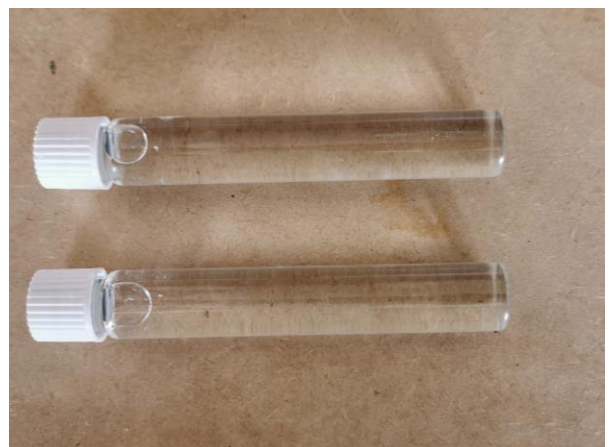
Figura 69. Absorción de agua del vial hasta formar una pequeña burbuja de aire
