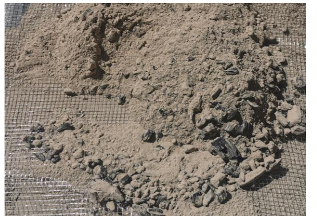
Figura 45. Ceniza de madera con residuos de carbón no combustionado
