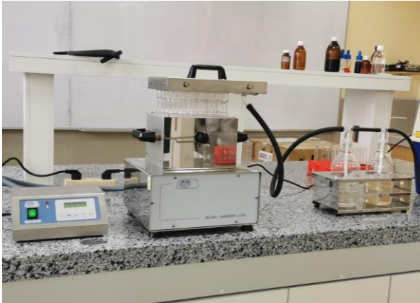
Figura 88. Digestor Kjeldahl para digestión de muestras de orina
