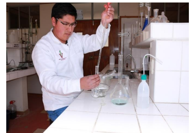
Figura 87. Adición de la solución digestora 3.5 mL (Ácido sulfúrico)
