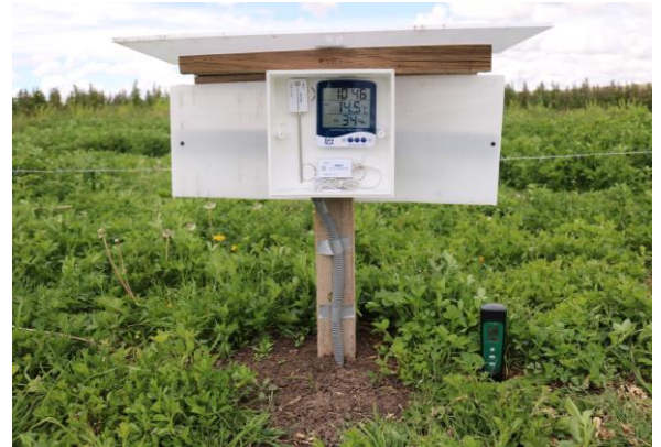
Figura 35. Estación meteorológica instalada con sensores de temperatura
