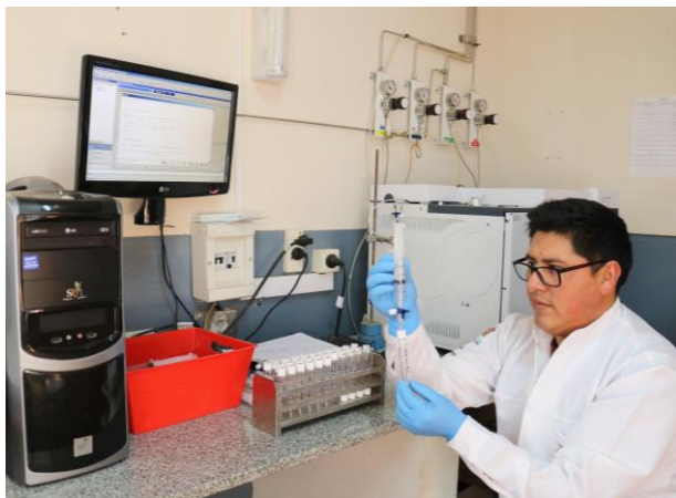
Figura 98. Extracción de 11 mL de muestra de aire para análisis
