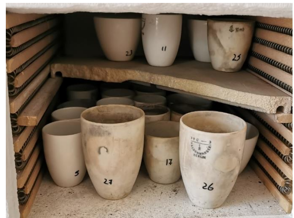
Figura 91. Crisoles con muestras de suelo en el interior de la mufla para incineración a 650 °C por 3 horas
