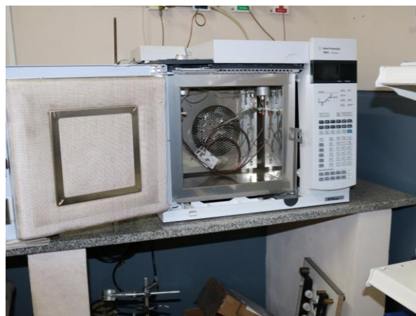
Figura 97. Vista interna del cromatógrafo de gases (Agilent 7890 A)
