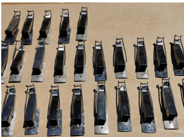
Figura 38. Construcción de cerrojos a presión tipo clips
