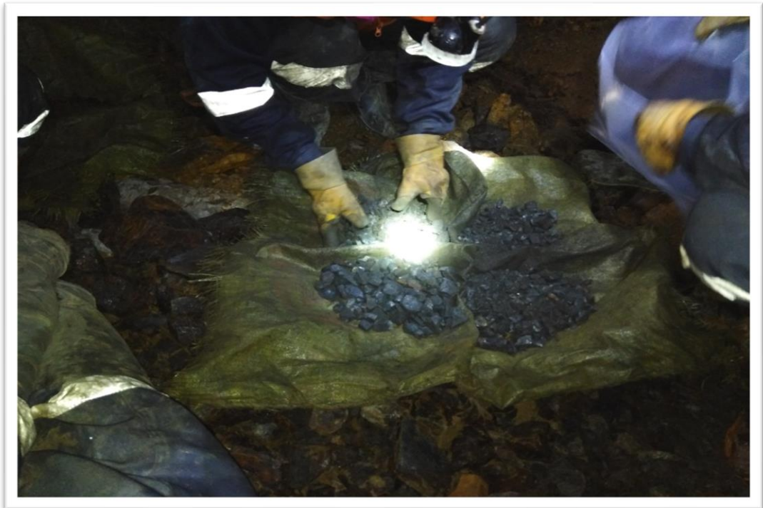
Figura 23. Cuarteo con Manta. Reducir (Toma 2 cuartos opuestos por vértice).
