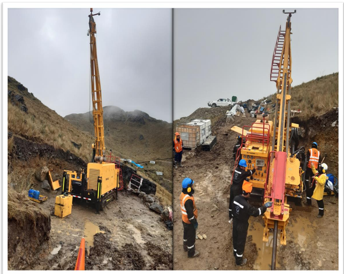
Figura 53. Plataforma de Perforación Diamantina. (Minera Pukamani)
