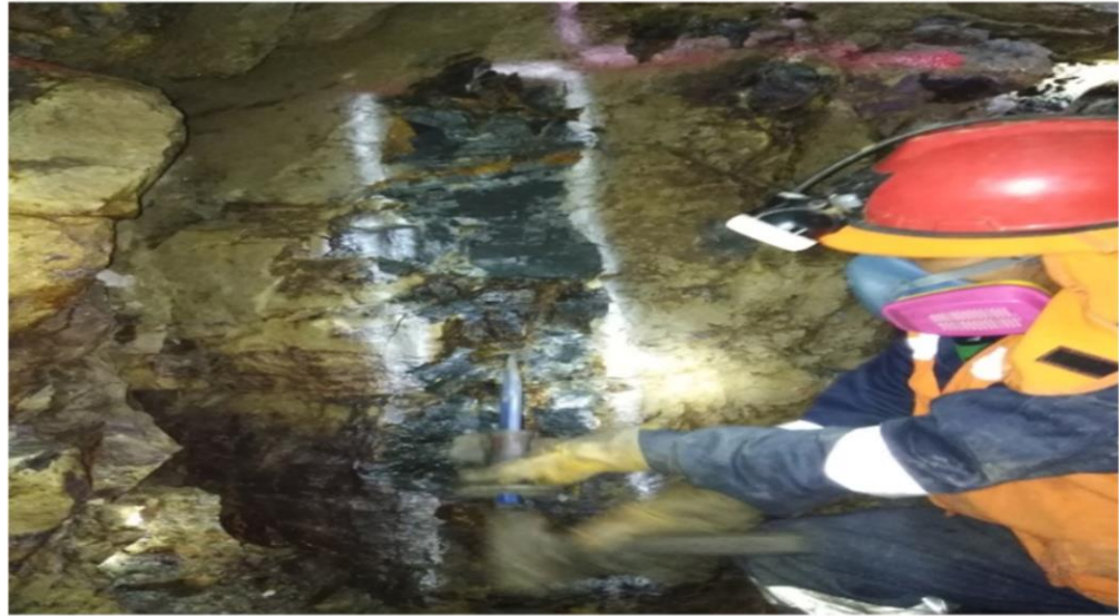
Figura 21. Muestreo con punta (cincel) y comba de 4 libras
