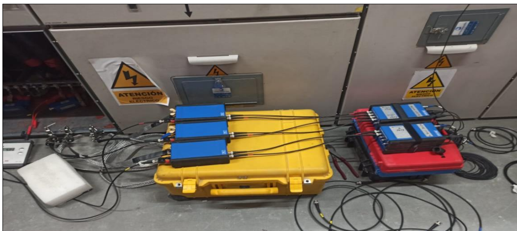
Figura 21: Equipo MPD800 ÓMICRON
