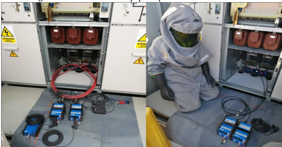
Figura 23: Conexión de equipo de prueba MPD800 ÓMICRON
