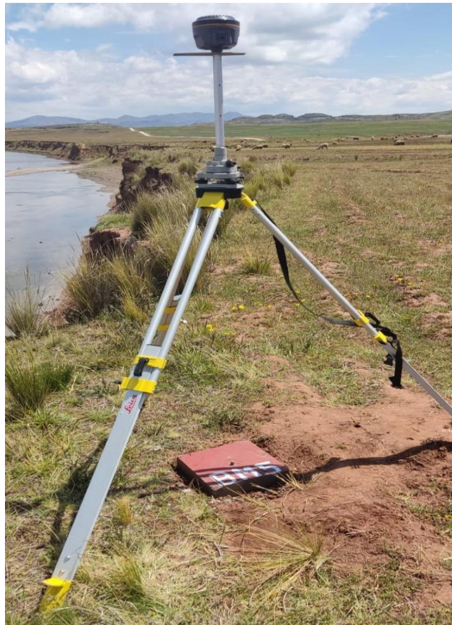
Figura 33. Colección de datos del BM5. Nota: Obtención de coordenadas con Receptor GNSS en Modo Estático.
