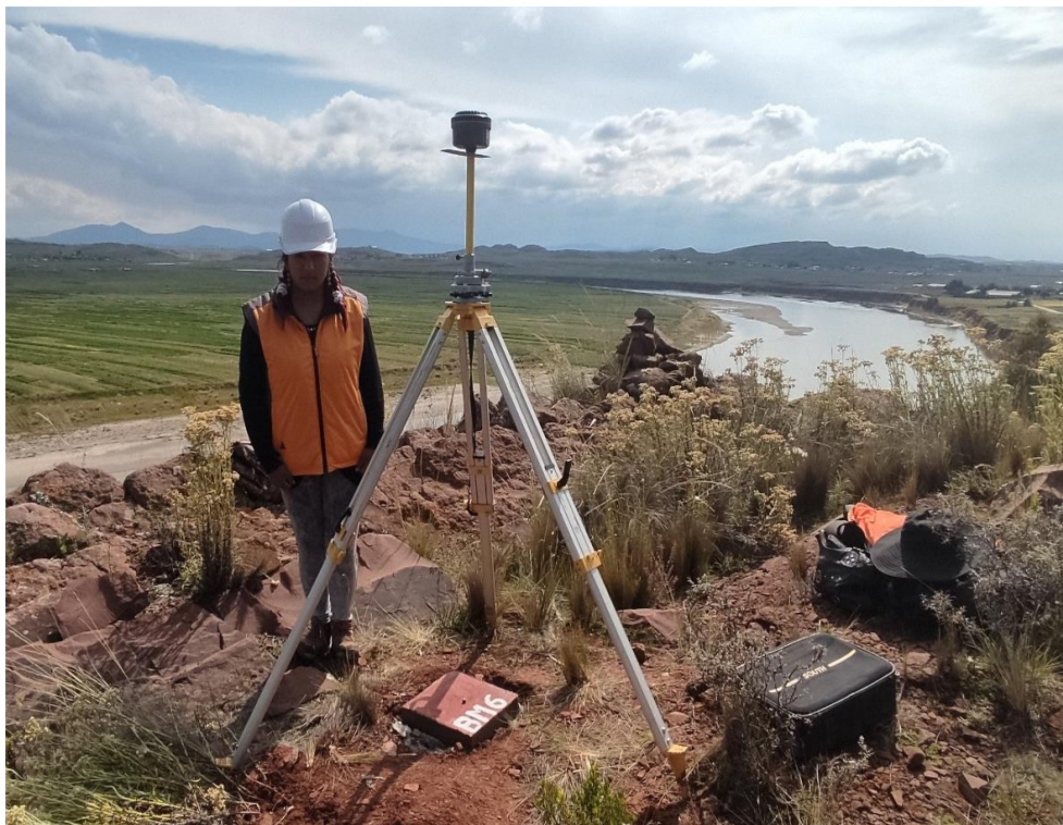
Figura 34. Colección de datos del BM6. Nota: Obtención de coordenadas con Receptor GNSS en Modo Estático.
