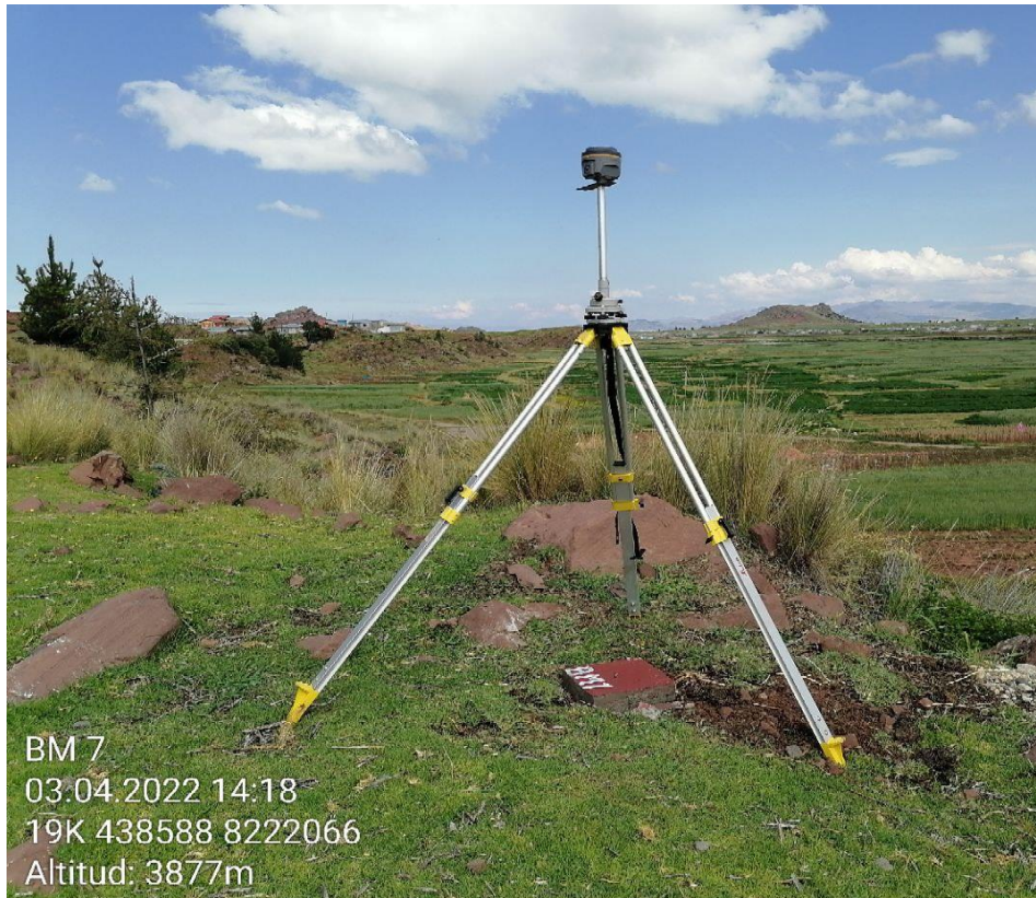
Figura 35. Colección de datos del BM7. Nota: Obtención de coordenadas con Receptor GNSS en Modo Estático.
