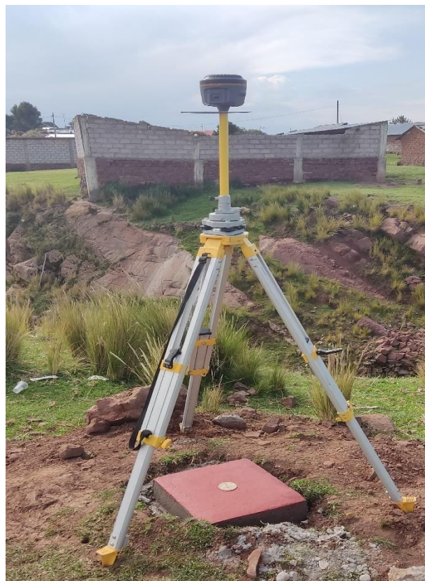
Figura 28. Colección de datos del punto PUN05162. Nota: Obtención de coordenadas con Receptor GNSS en Modo Estático.
