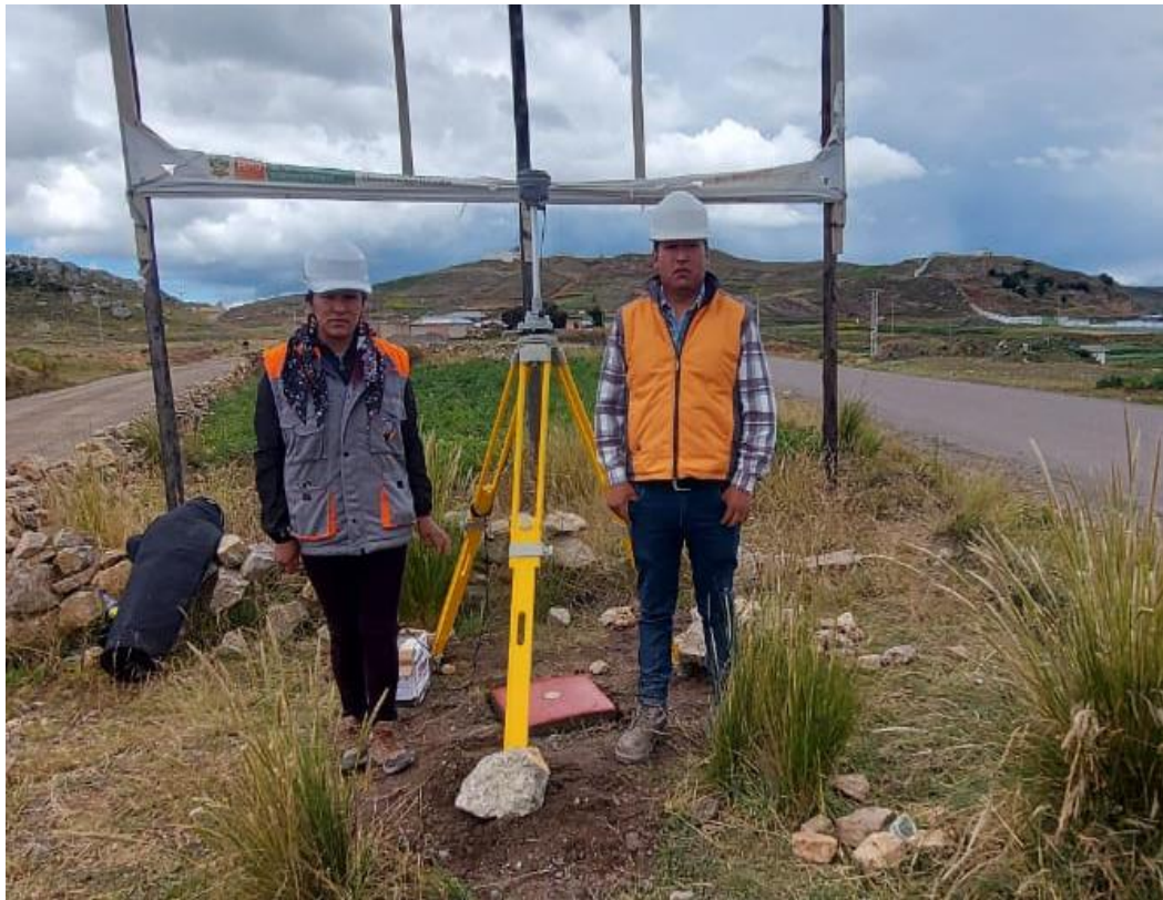
Figura 27. Colección de datos del punto PUN05161. Nota: Obtención de coordenadas con Receptor GNSS en Modo Estático.
