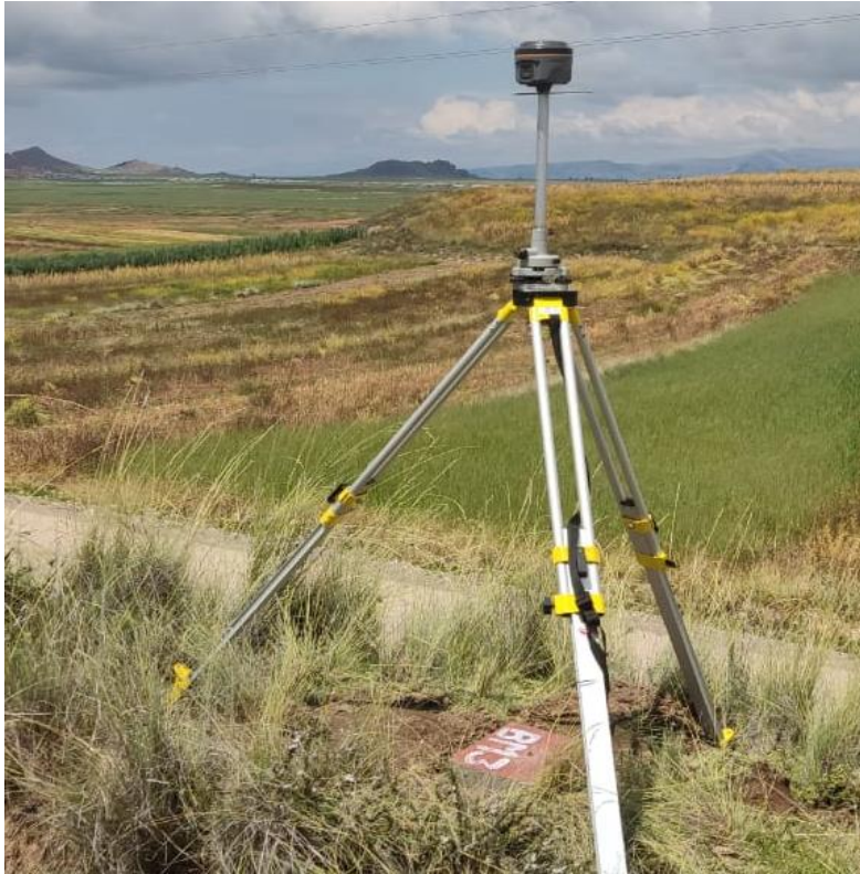
Figura 31. Colección de datos del BM3. Nota: Obtención de coordenadas con Receptor GNSS en Modo Estático.
