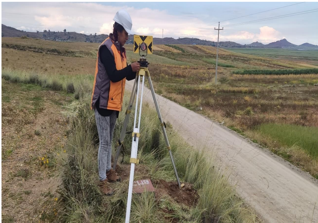
Figura 26. Base nivelante. Nota: Referencia vista atrás.
