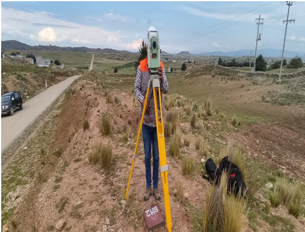
Figura 25. Lectura de Ángulos. Nota: Obtención de Ángulos y Distancias en campo.
