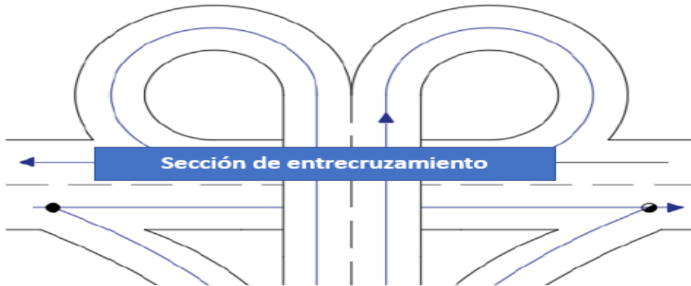
Figura 7. Sección de entrecruzamiento en un Trébol.
