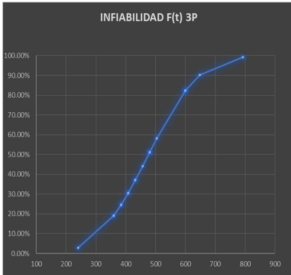
Figura 36: Curva de Infiabilidad de la balanza automática de insumos
