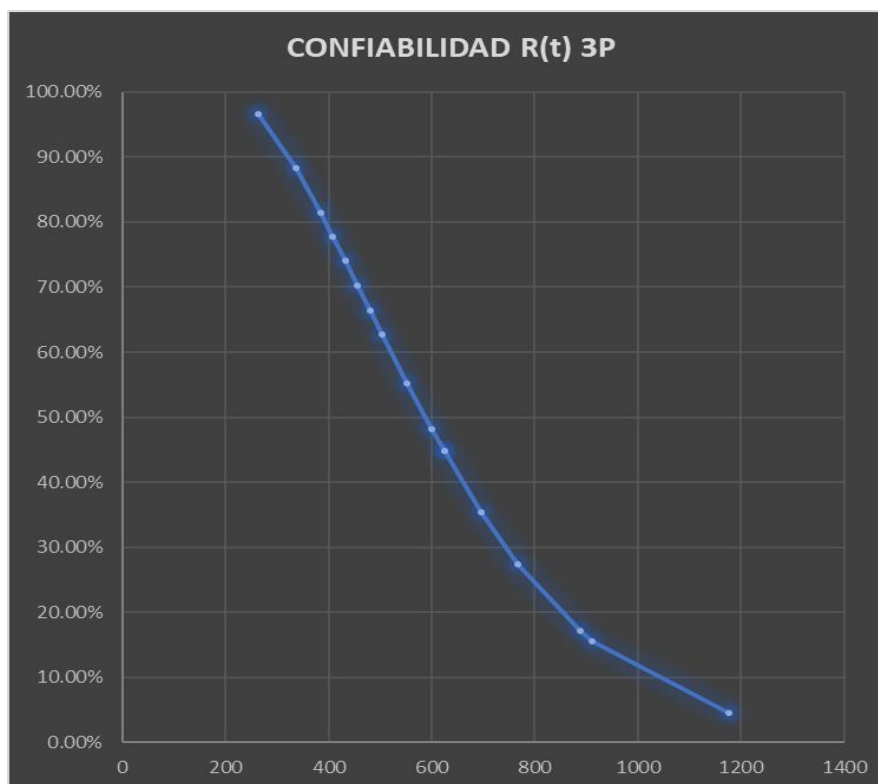
Figura 47: Curva de Confiabilidad balanza automática de líquidos
