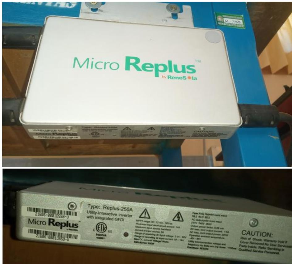
**Figura 21:** Microinversor solar REPLUS instalado en el Laboratorio de Control y Automatización de Procesos de EPIME.
