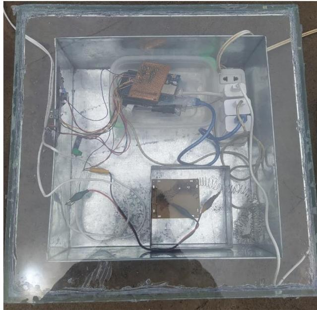
Figura B.1. Módulo de adquisición de datos con resistencia interna.
