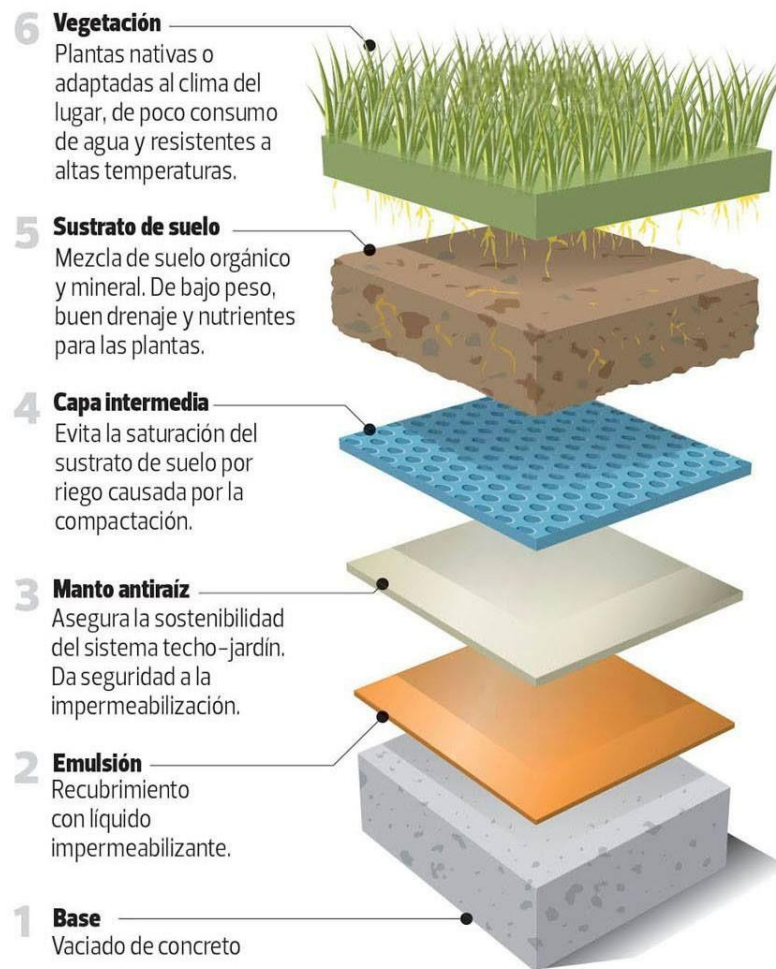
Figura 52. Tendido de Techo Verde.
