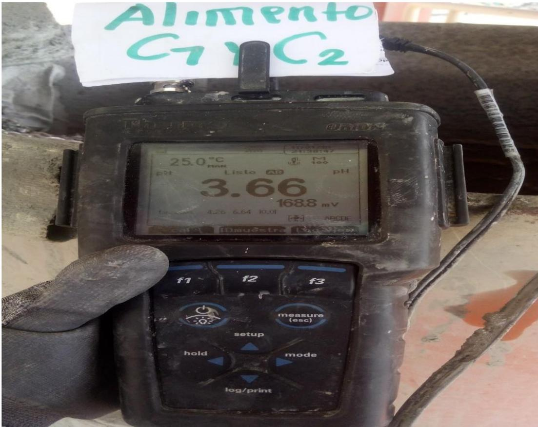
**Figura 39.** Medicion de pH de agua de lavado celda columna 1 y 2
