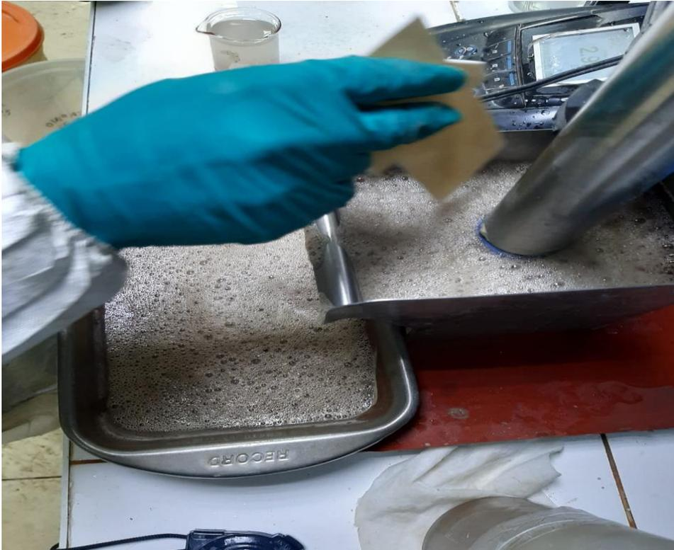
**Figura 33.** Flotación Casiterita 2 a nivel Laboratorio.
