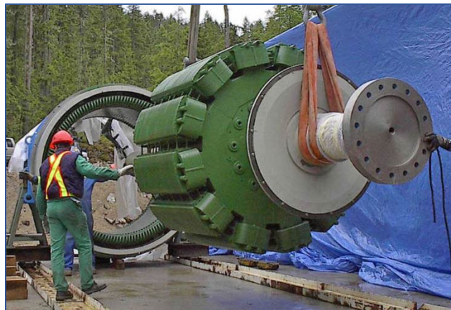
Figura 1. Máquina Síncrona de Rotor de polos salientes Fuente: Morejón & Pérez (2015)
