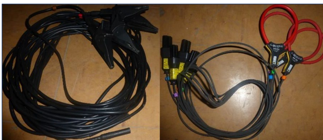
Figura 37. Accesorios, sensor de corriente y tensión del analizador trifásico
