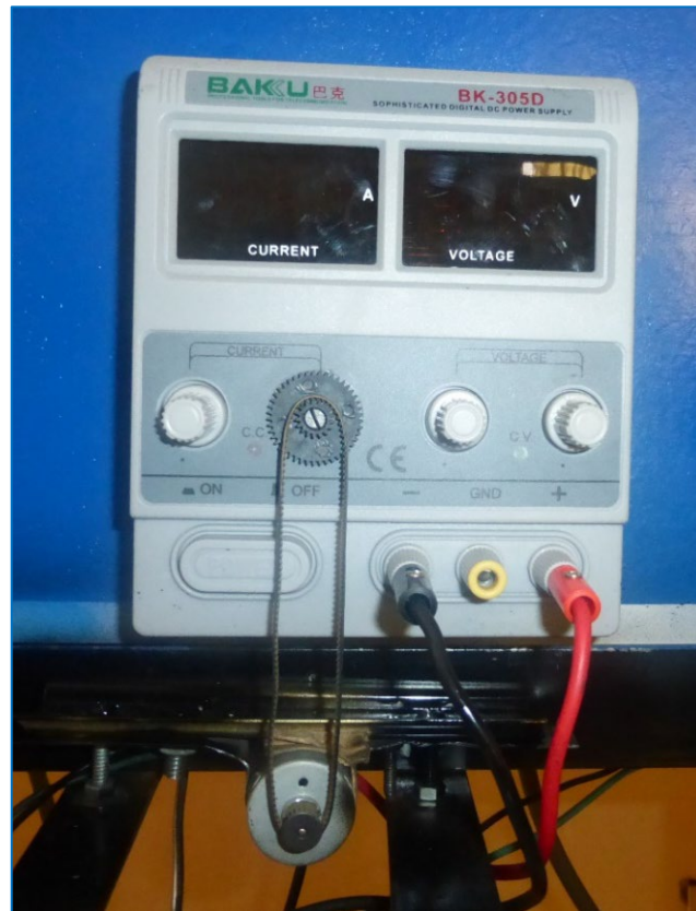
Anexo 7. Servomotor que regula la corriente de excitación
