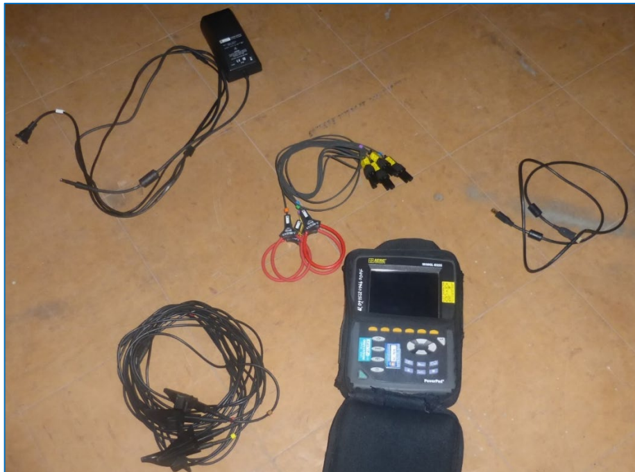
Anexo 8. Analizador de red y sus accesorios como sensor de corriente y tensión
