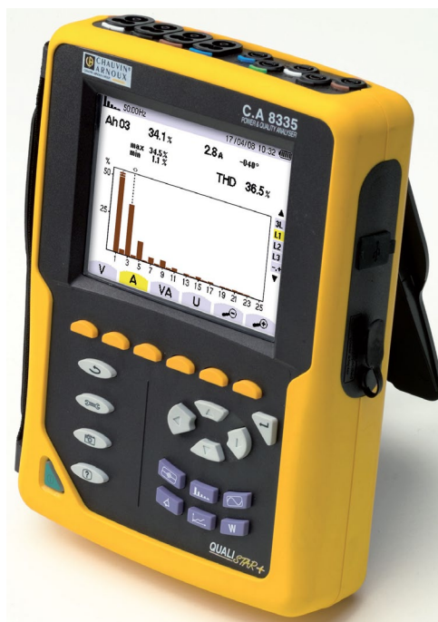
Figura 36. Analizador trifásico modelo Chauvin Arnoux C.A Fuente: Arnoux (2012).
