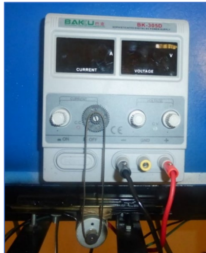
Figura 38. Motor DC de 24v DC acondicionado a la fuente DC
