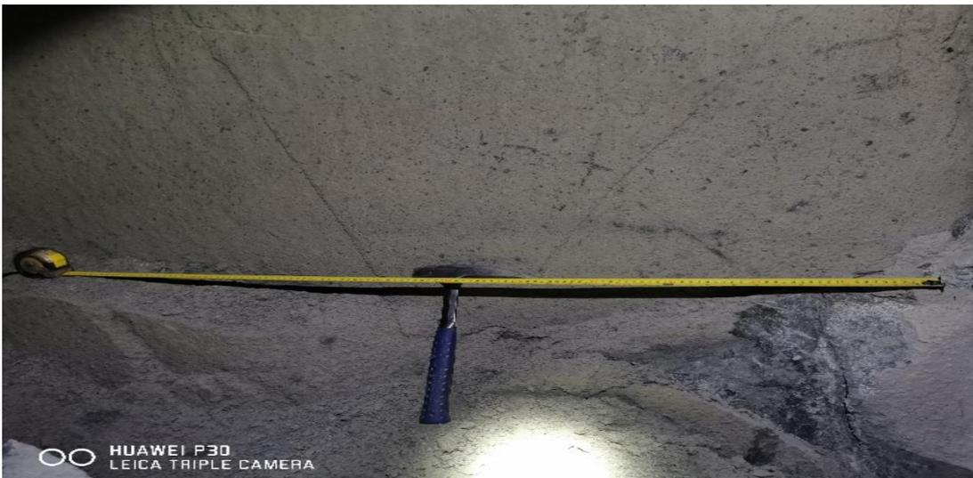
Imagen (G) medición de fracturas en la caja techo
