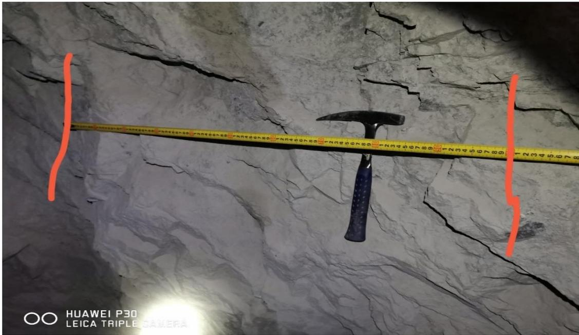
Imagen (H) medición de fracturas en la caja piso
